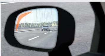
後方から接近する車両の存在を知らせ、隣接する車両との衝突の危険度が高くなるとステアリングを修正するステアリング・アシスト付BLIS™（ブラインド・スポット・インフォメーション）や駐車スペースから後退して出庫する際に接近する車両、歩行者やサイクリストとの衝突の危険を警告する衝突回避・被害軽減ブレーキ機能付CTA（クロス・トラフィック・アラート）など、周囲の車両や障害物に関する情報と支援をドライバーに提供します。
