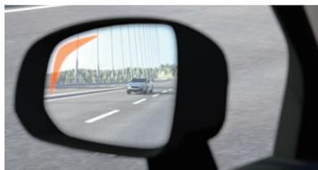
後方から接近する車両の存在を知らせ、隣接する車両との衝突の危険度が高くなるとステアリングを修正するステアリング・アシスト付BLIS™（ブラインド・スポット・インフォメーション）や駐車スペースから後退して出庫する際に接近する車両、歩行者やサイクリストとの衝突の危険を警告する衝突回避・被害軽減ブレーキ機能付CTA（クロス・トラフィック・アラート）など、周囲の車両や障害物に関する情報と支援をドライバーに提供します。
