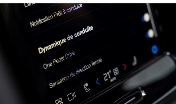
Le freinage régénératif permet de recharger la batterie. [Cela participe à l'écoconduite](#), une façon de conduire nouvelle, qui vise à optimiser l'autonomie de sa voiture 100 % électrique. Comme, par exemple, relâcher la pédale d'accélérateur le plus souvent possible, que ce soit en pente ou avant un feu rouge, pour regagner un peu d'autonomie.
