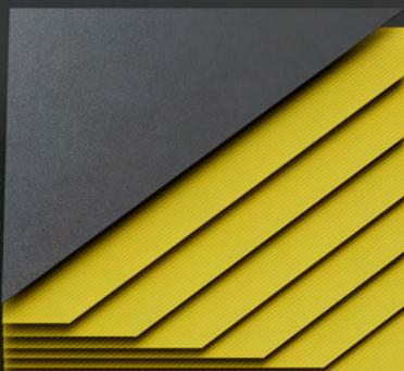
La couverture en aramide est fabriquée à partir de Kevlar® qui est tissé, empilé en couches avec la jonction d'un film thermoplastique, en utilisant un processus hautement contrôlé en autoclave avec application d'une pression et d'une température élevées.
