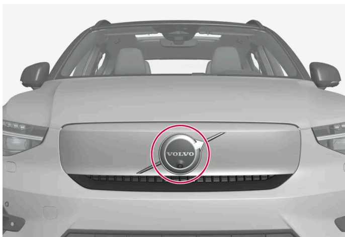
Umístění přední radarové jednotky
