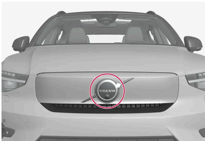
Umístění přední radarové jednotky
