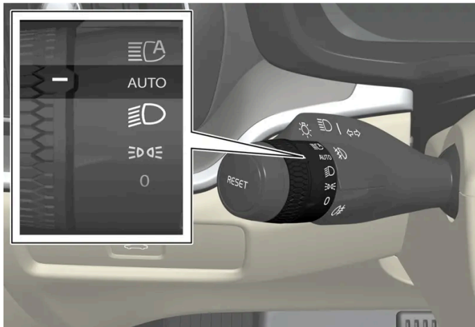
Otočný prsteneček na páčkovém přepínači v poloze AUTO.
