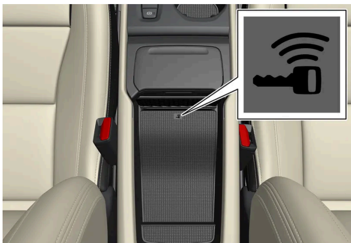
Umístění záložní čtečky v tunelové konzole.
