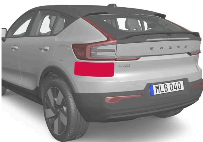
Umístění zadních radarových jednotek
