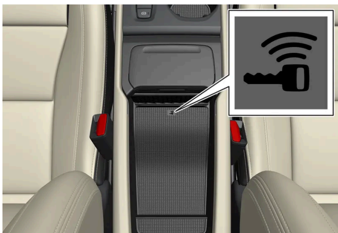
Umístění záložní čtečky v tunelové konzole.
