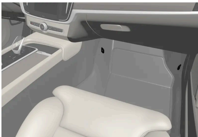
Umístění upevňovacích bodů na předním sedadle.
