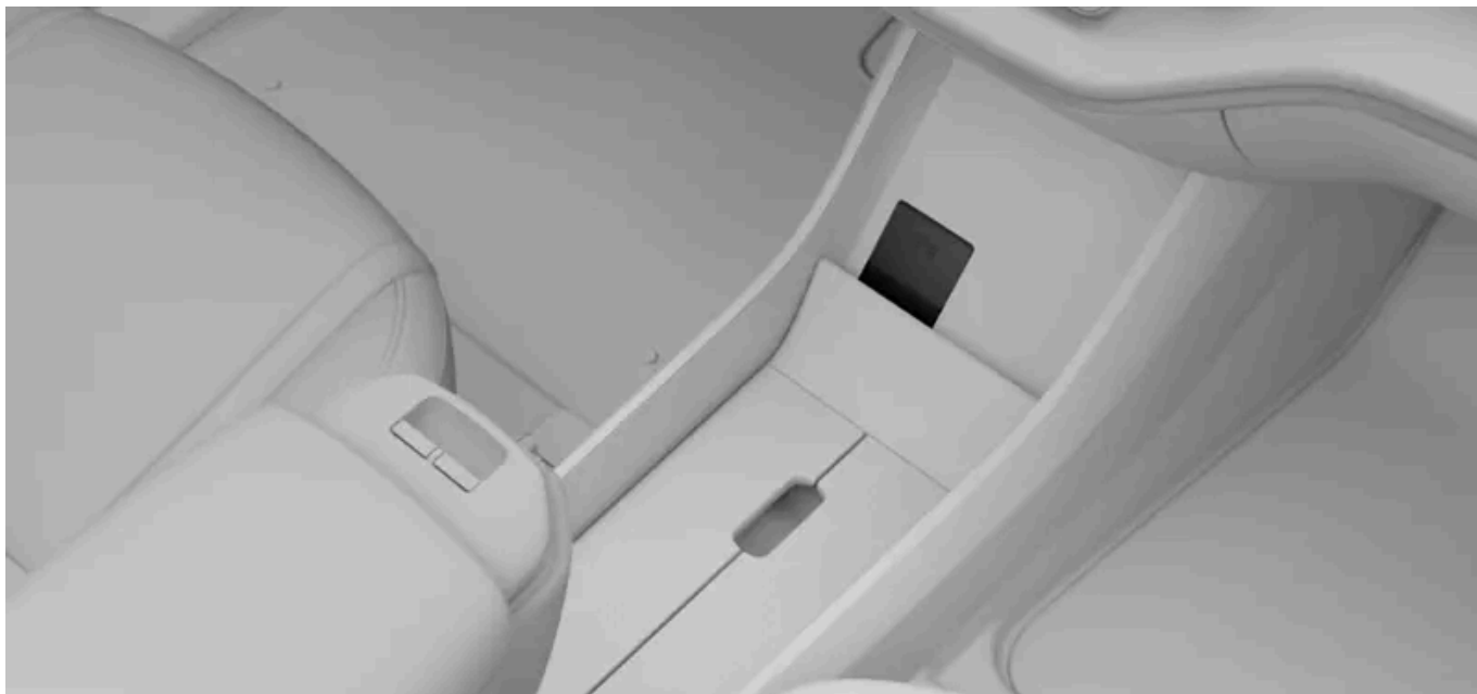
Bezdrátová nabíječka pod displejem
