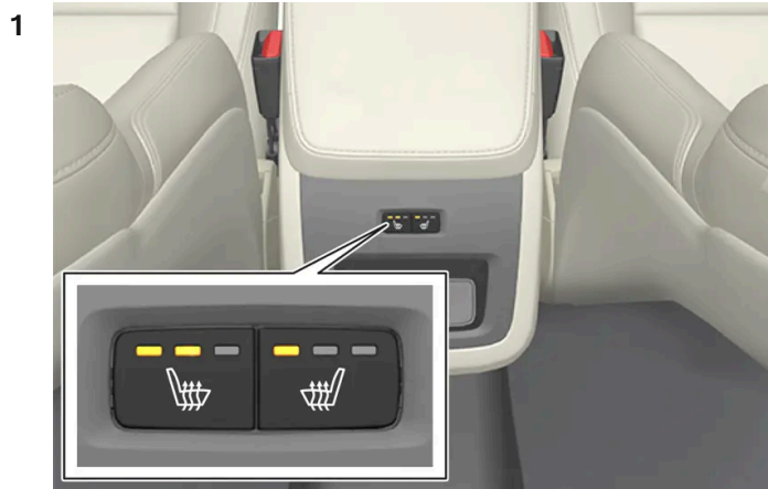
Tlačítka vyhřívání sedadel vzadu na tunelové konzole.
