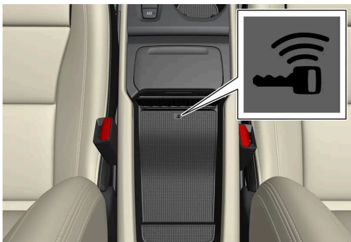
Umístění záložní čtečky v tunelové konzole.
