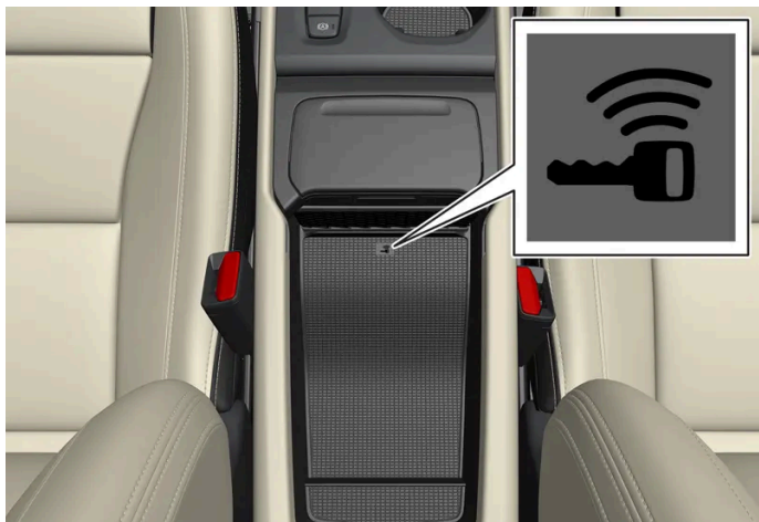
Umístění záložní čtečky v tunelové konzole.
