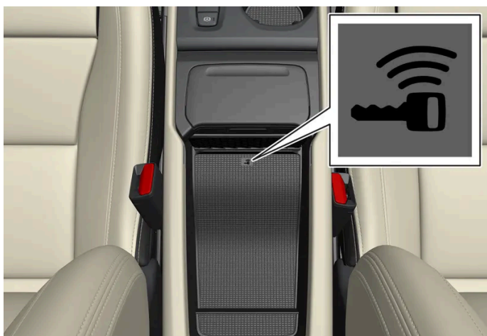
Umístění záložní čtečky v tunelové konzole.
