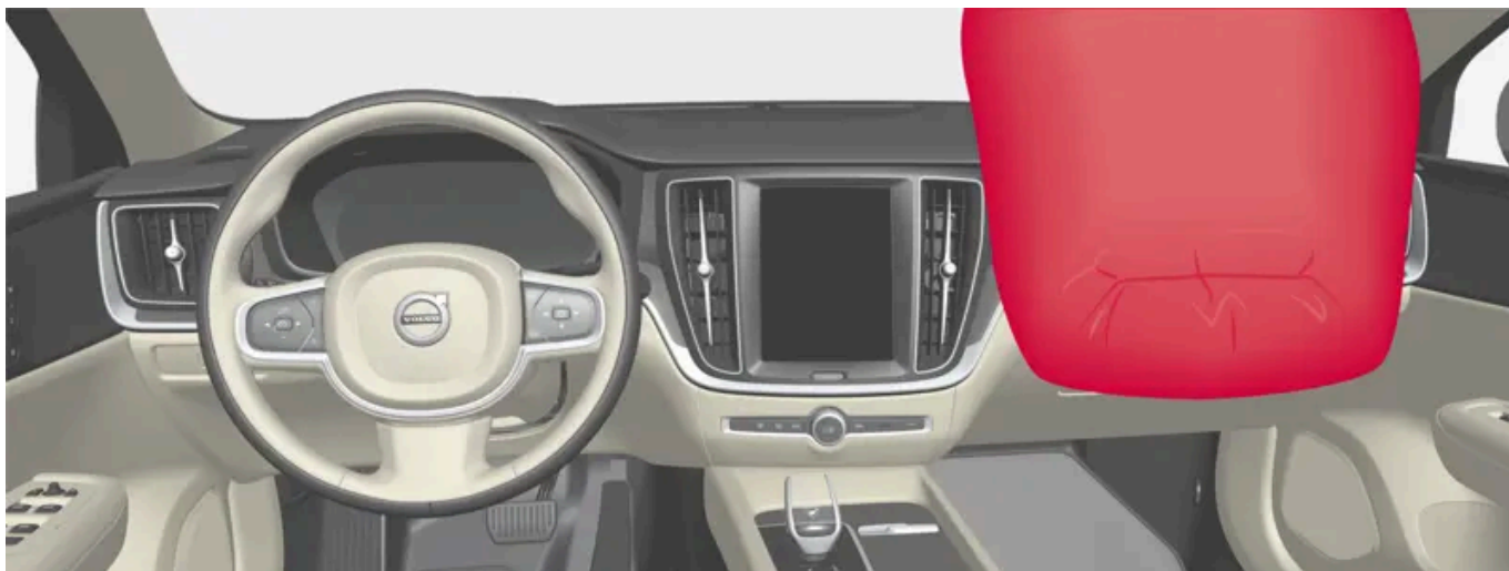
Airbag předního spolujezdce na předním sedadle.
