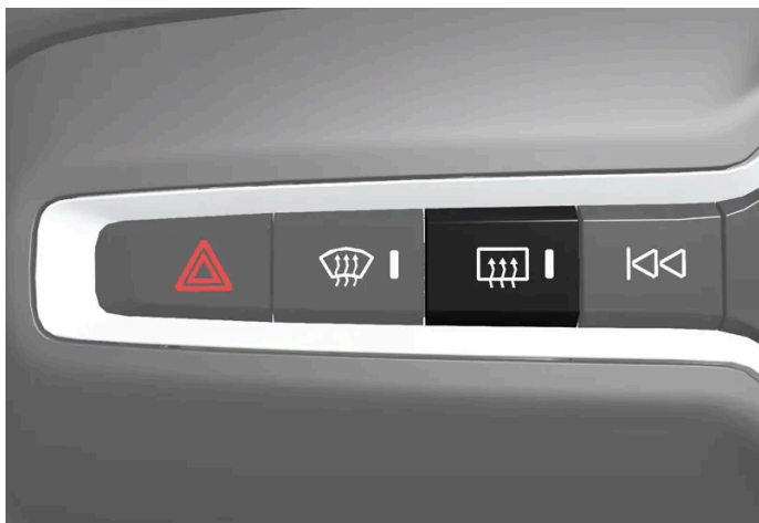
Fyzické tlačítko na středové konzole.
