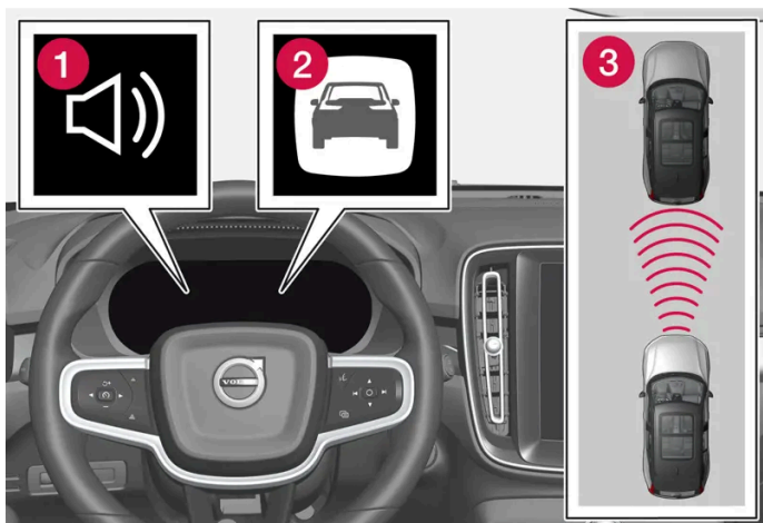
Audio a symbol varování před kolizí
