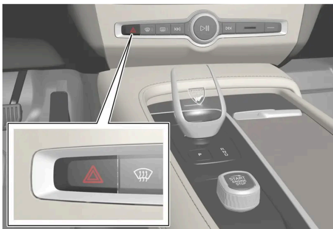
Tlačítko pro výstražnou funkci ukazatelů směru.
