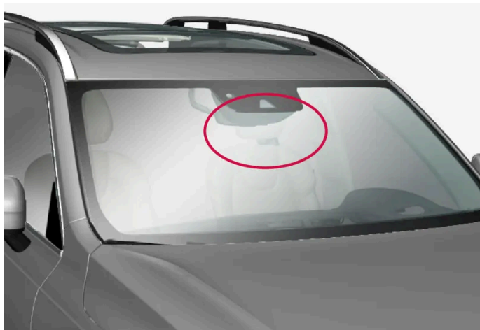
Umístění přední kamerové jednotky
