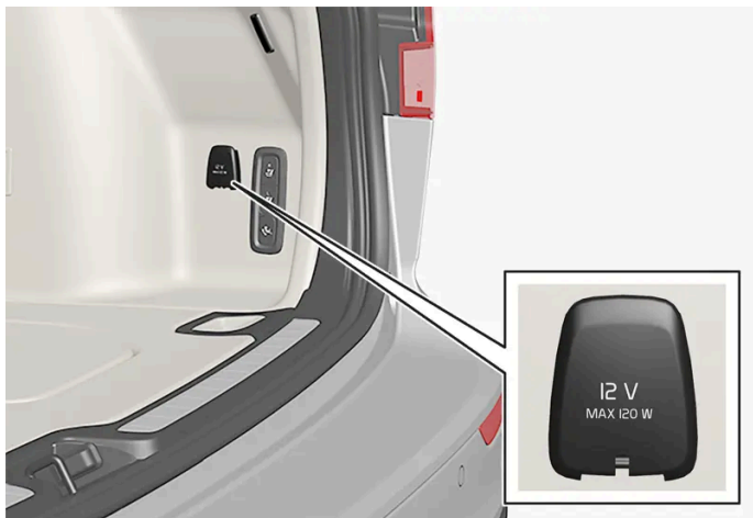
Elektrická zásuvka 12 V v zavazadlovém prostoru*.
