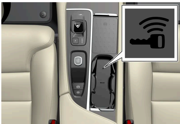
Umístění záložní čtečky v tunelové konzole.
