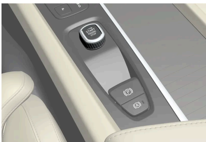
Startovací knoflík na tunelové konzole.
