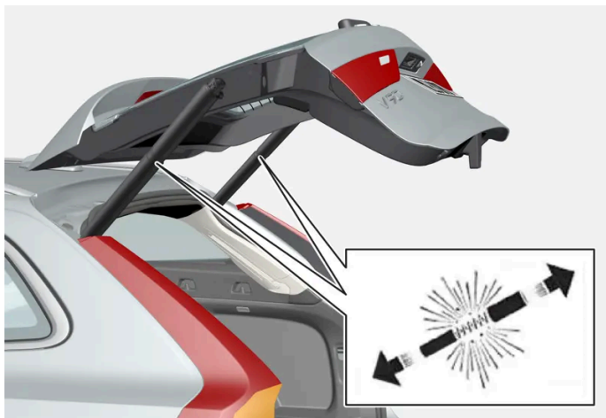
Předeprnuté pružiny pro elektricky ovládané zadní výklopné dveře.
