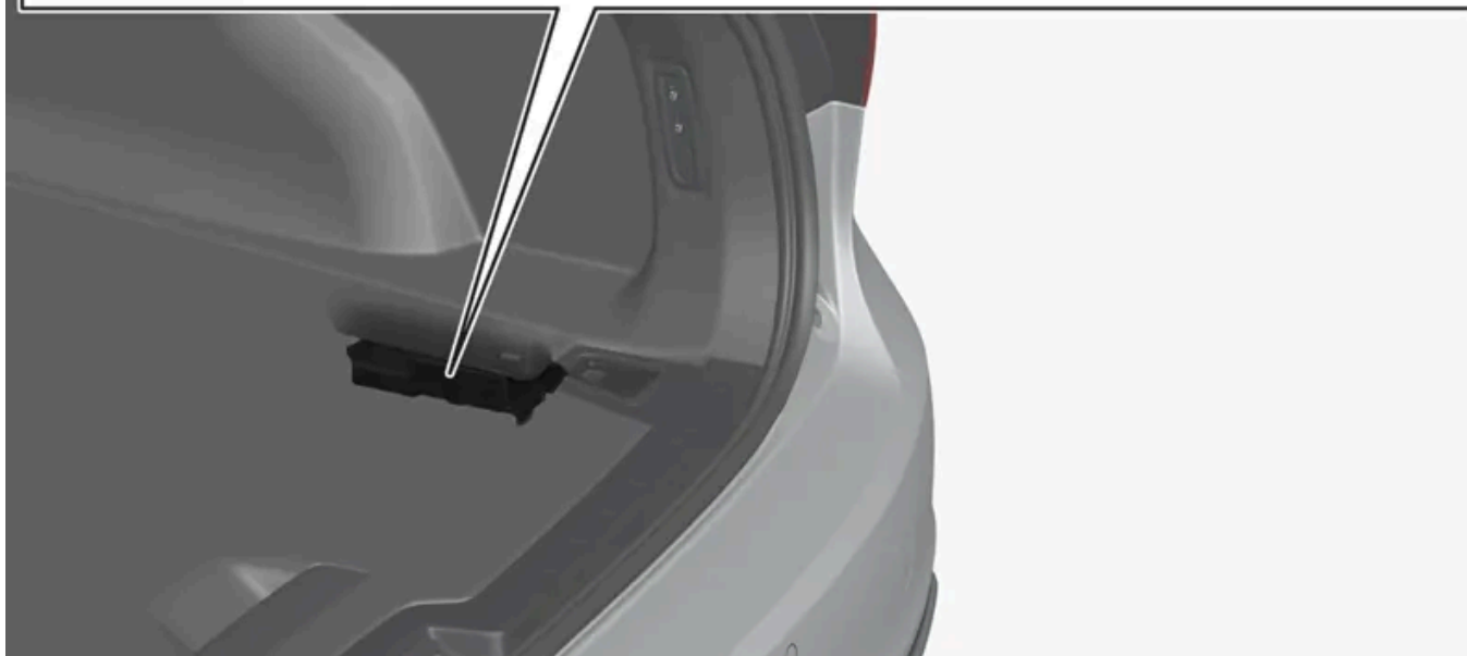
Centrální elektrická jednotka se nachází za panelem na pravé straně.
