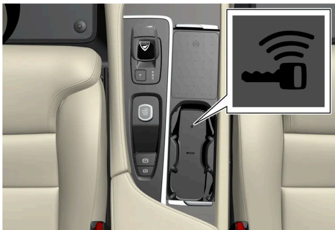
Umístění záložní čtečky v tunelové konzole.
