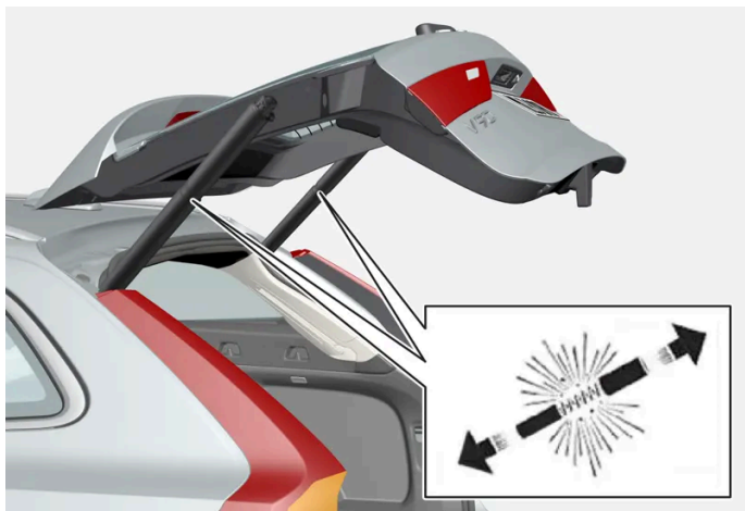
Předeprnuté pružiny pro elektricky ovládané zadní výklopné dveře.
