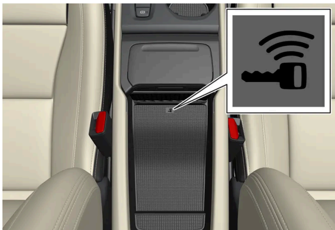
Umístění záložní čtečky v tunelové konzole.
