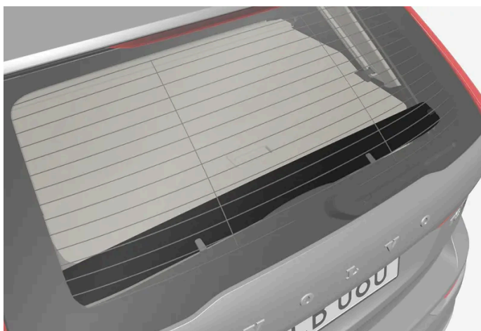
Kryt zavazadlového prostoru doplňuje zadní panel, který se instaluje na vnitřní stranu víka zavazadlového prostoru.
