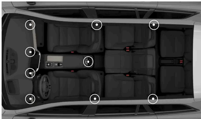
Umístění nastavitelných ventilačních otvorů
