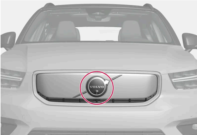
Anordnung der vorderen Radareinheit
