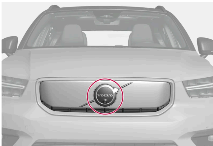
Anordnung der vorderen Radareinheit
