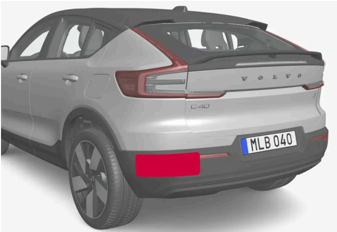
Platzierung der hinteren Radareinheiten
