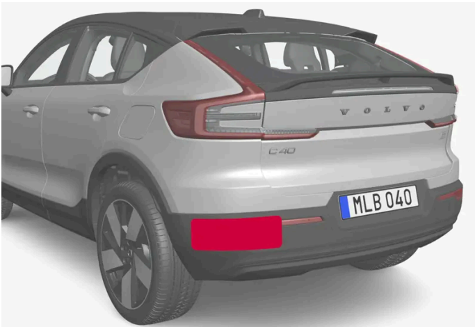
Platzierung der hinteren Radareinheiten
