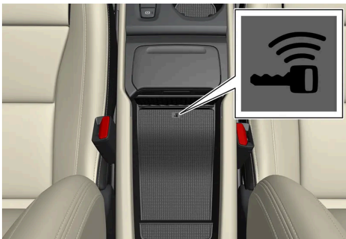
Lage des Schlüssellesegeräts an der Tunnelkonsole.
