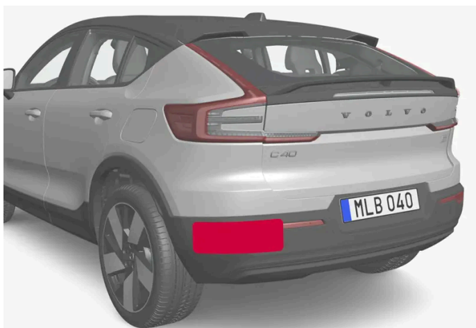
Platzierung der hinteren Radareinheiten
