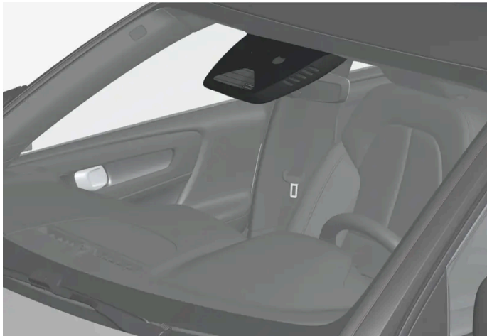
Platzierung der Kameraeinheit
