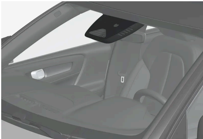
Platzierung der Kameraeinheit
