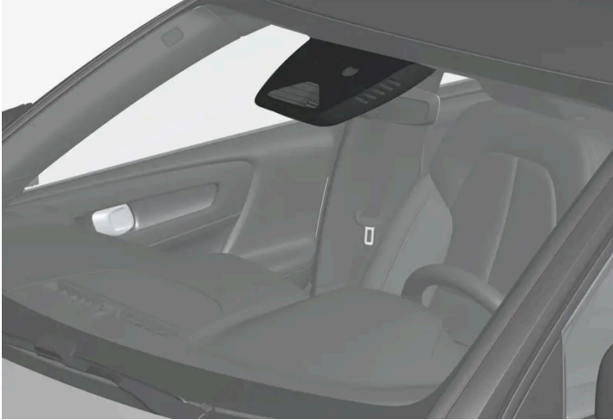
Platzierung der Kameraeinheit
