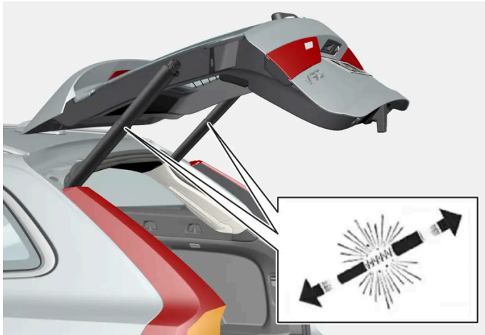
Vorgespannte Federn der elektrisch betätigten Heckklappe.
