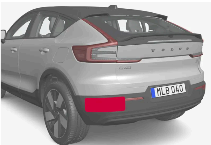
Platzierung der hinteren Radareinheiten
