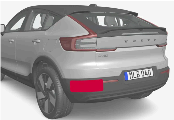
Platzierung der hinteren Radareinheiten
