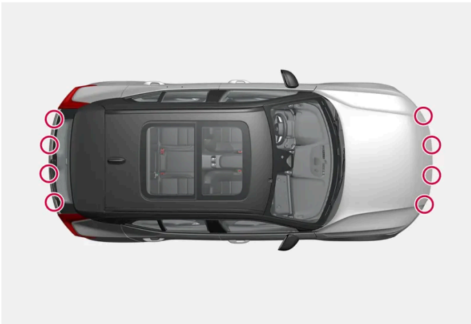
Anordnung der Einparkhilfesensoren rund um das Fahrzeug
