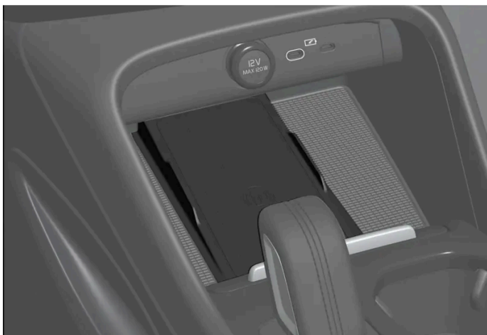
Induktives Smartphone-Ladesystem vor dem Schalt-/Wählhebel
