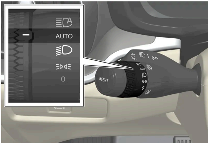
Drehring am Lenkradhebel in Stellung AUTO .
