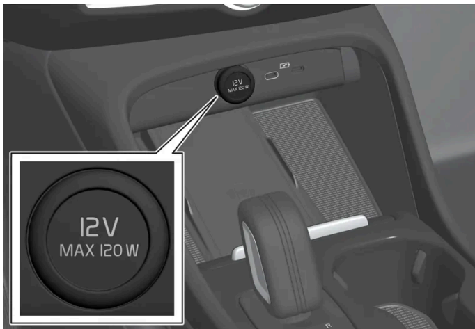
12-V-Steckdose in der Tunnelkonsole, vorn.
