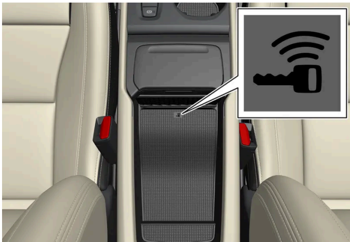
Lage des Schlüssellesegeräts an der Tunnelkonsole.
