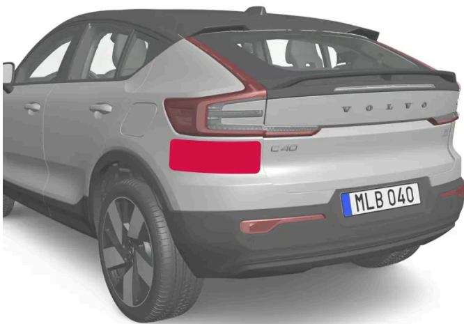
Platzierung der hinteren Radareinheiten
