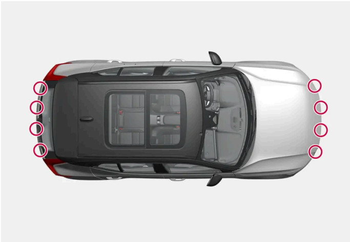
Lage der Einparkhilfesensoren rund um das Fahrzeug
