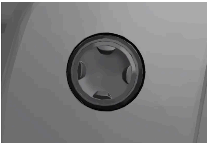
Seitlich am Sitzpolster angebrachter Vierwegeschalter.
