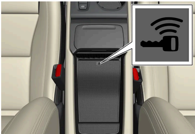
Lage des Schlüssellesegeräts an der Tunnelkonsole.
