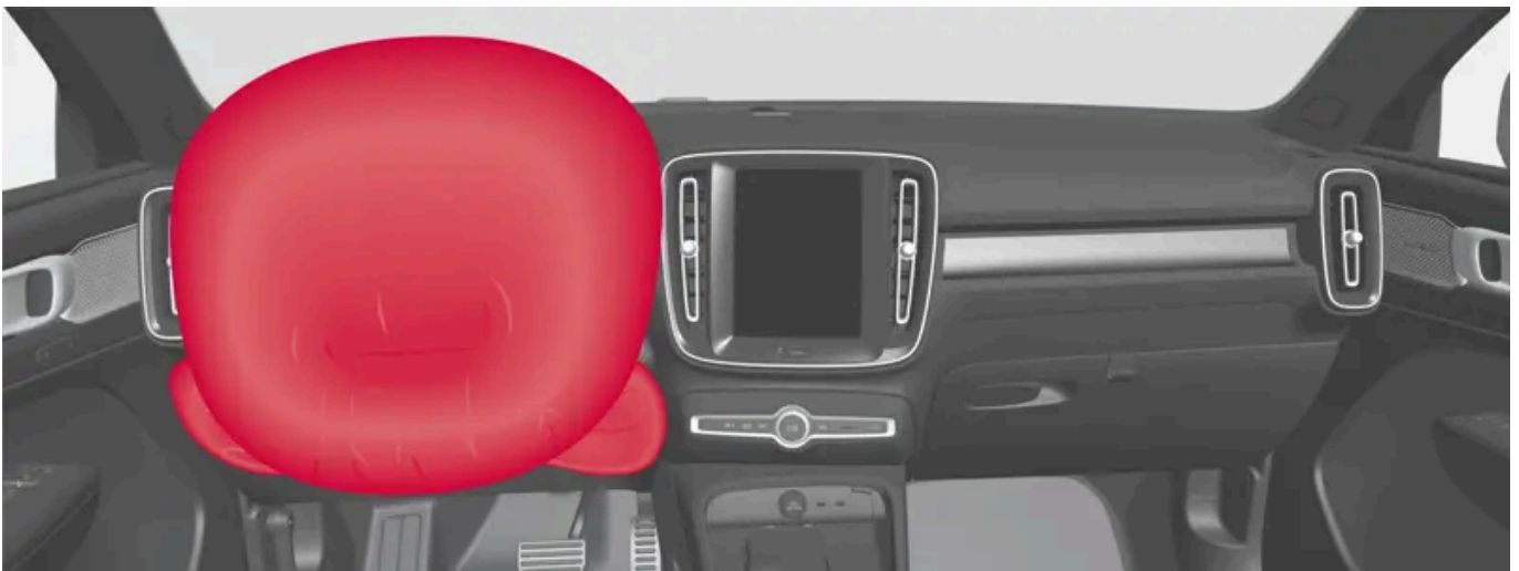
Lenkrad-Airbag und Knie-Airbag [1] am Fahrersitz.
