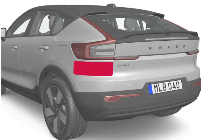
Lage der hinteren Radarmodule
