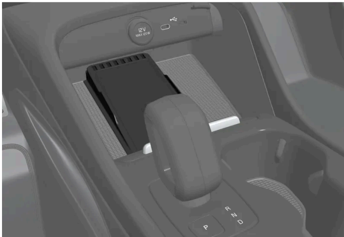
Induktives Smartphone-Ladesystem vor dem Schalt-/Wählhebel
