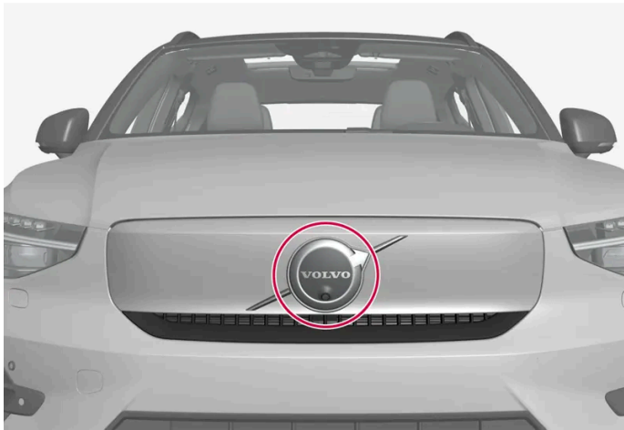
Anordnung der vorderen Radareinheit
