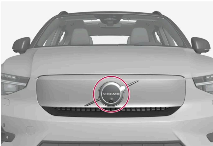
Anordnung der vorderen Radareinheit
