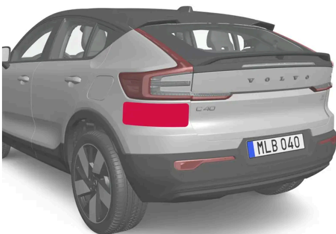
Lage der hinteren Radarmodule
