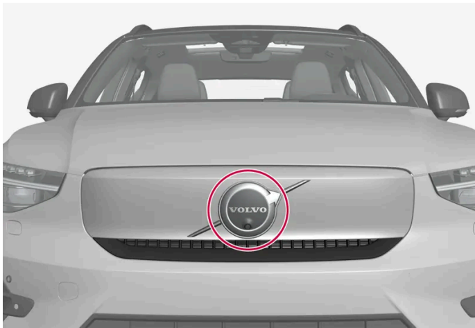
Lage des vorderen Radarmoduls
