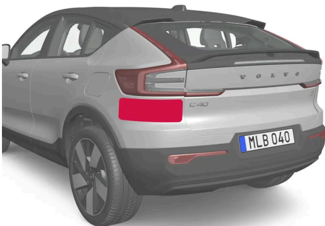
Platzierung der hinteren Radareinheiten
