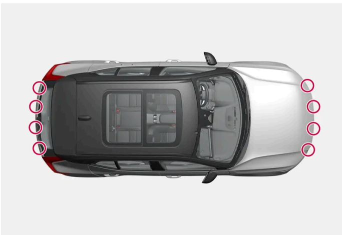
Lage der Einparkhilfesensoren rund um das Fahrzeug
