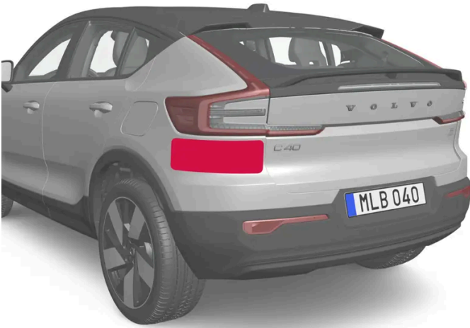
Lage der hinteren Radarmodule
