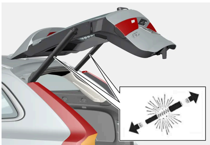
Vorgespannte Federn der elektrisch betätigten Heckklappe.
