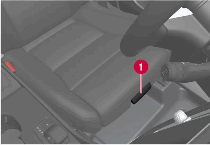
Schalter zur Längenverstellung des Sitzpolsters.
