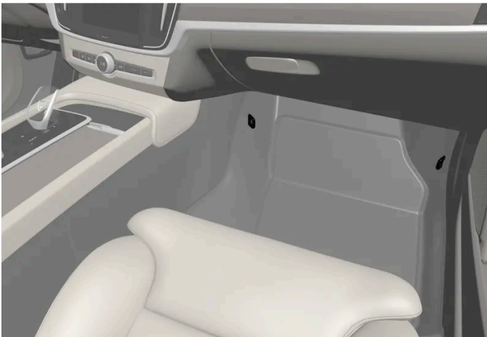
Lage der Befestigungspunkte für den Vordersitz
