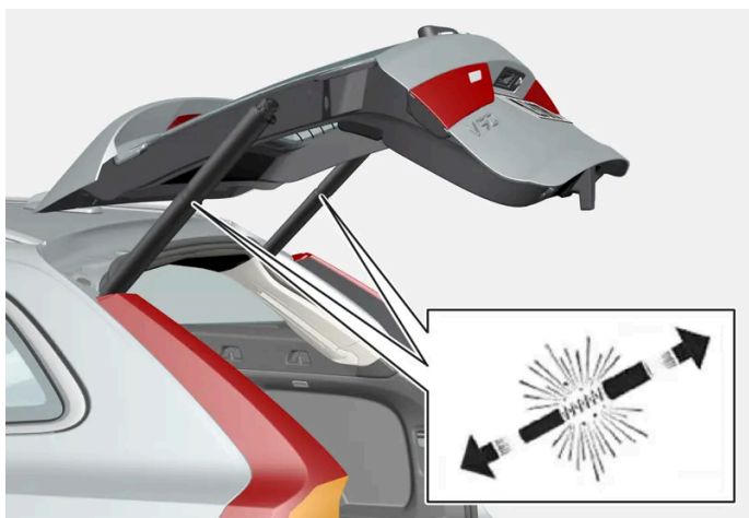
Vorgespannte Federn der elektrisch betätigten Heckklappe.
