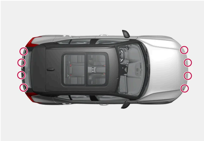
Lage der Einparkhilfesensoren rund um das Fahrzeug
