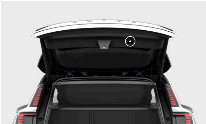
Lage der Taste zum Schließen der Heckklappe.
