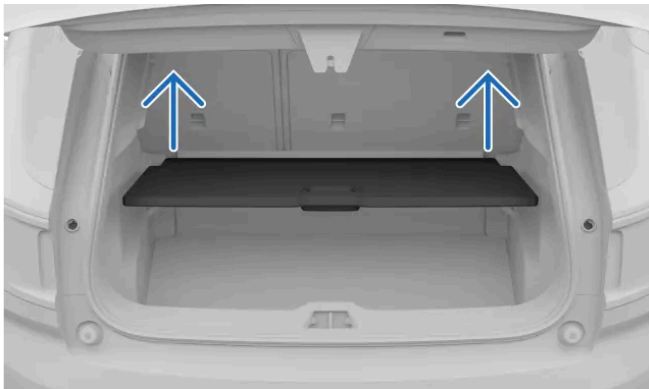
Abbildung zum Herausnehmen der Bodenklappe im Kofferraum.
