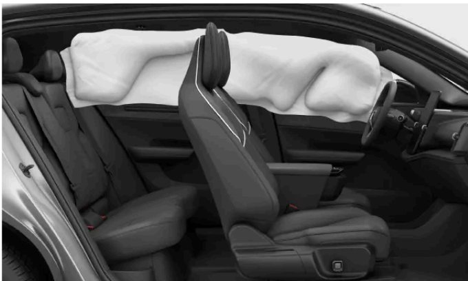
Auf einer Seite des Fahrzeugs ausgelöster Kopf-/Schulterairbag.
