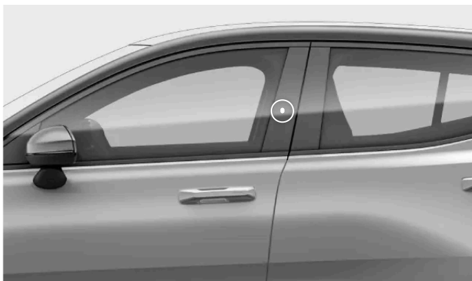
Schlüsselerkennungsbereich an der Fahrertürsäule.
