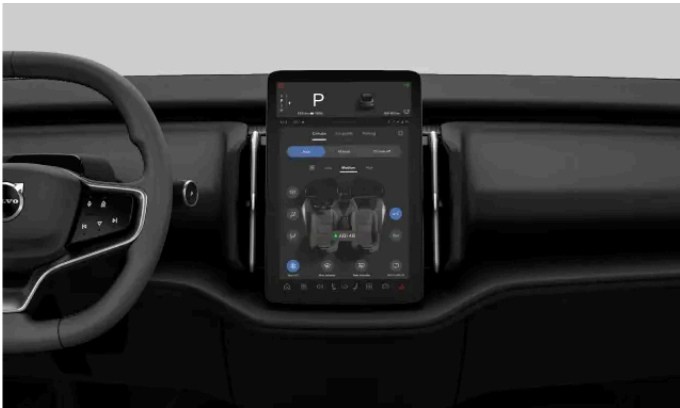
Bedienelemente der Klimaanlage auf dem Display
