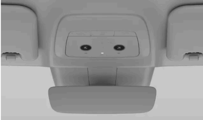
Die Leseleuchten für die Vordersitze in der Deckenkonsole
