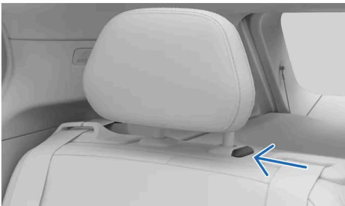
Verriegelungstaste an der Kopfstütze
