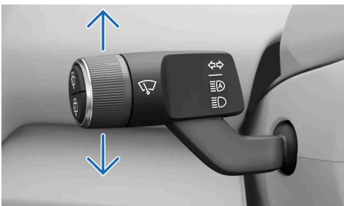
Blinker am linken Lenkradhebel
