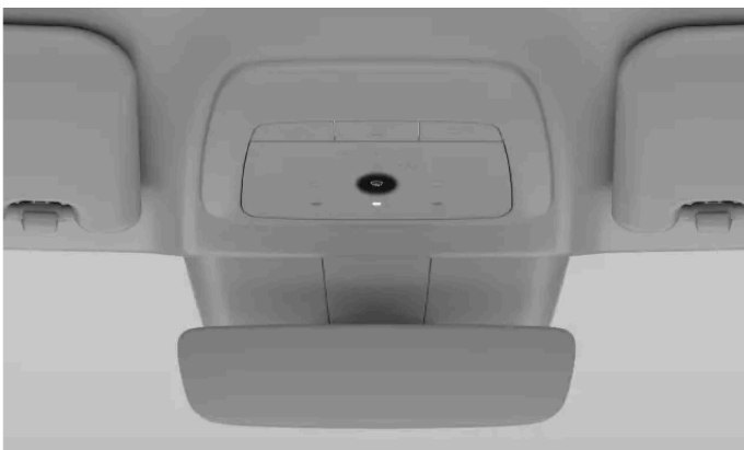
Enteisungstaste an der Deckenkonsole
