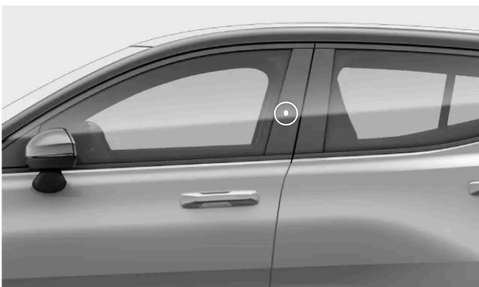
Schlüsselerkennungsbereich an der Türsäule
