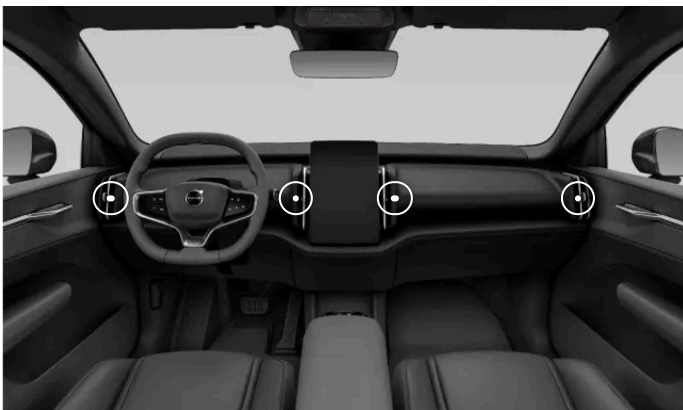
Lage der verstellbaren Lüftungsdüsen.
