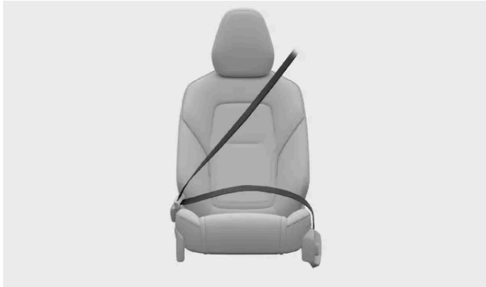
Richtig angelegter und eingestellter Sicherheitsgurt.
