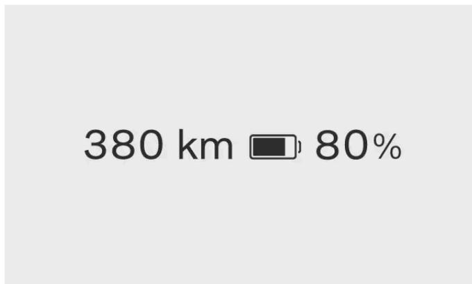
Die Batterieanzeige ist jederzeit im Displaybereich für die Fahrerinformationen sichtbar. Je nachdem, welchen Ladezustand die Batterie aufweist, ändert sich die Farbe des Batteriesymbols.
