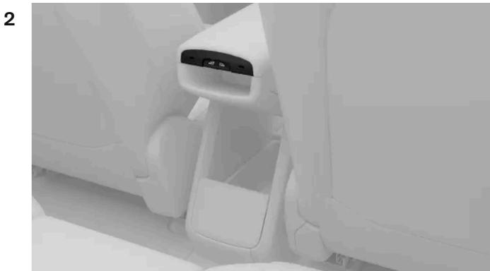
Im Fond können Sie die hinteren Fenster über die Tasten bedienen, die sich am hinteren Ende der mittleren Armlehne befinden.
