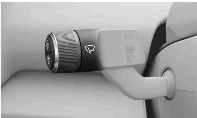
Sie bedienen die Scheibenwischer und -waschanlage mit dem Stellrad und den Tasten am linken Lenkradhebel.
