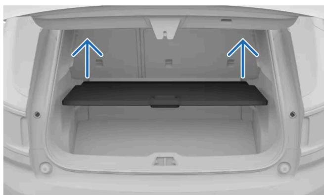
Abbildung zum Herausnehmen der Bodenklappe im Kofferraum.
