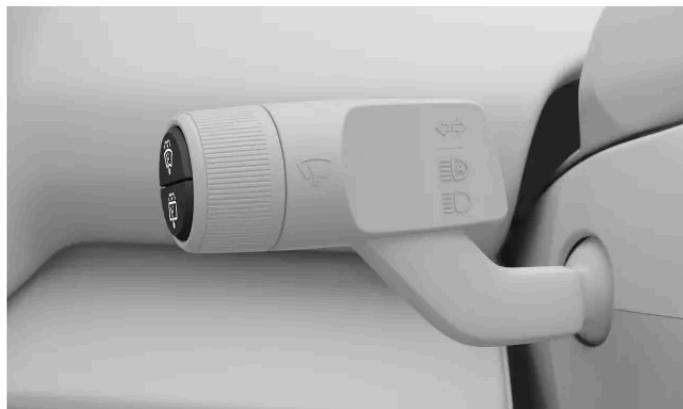
Tasten für die Scheibenwaschanlage am linken Lenkradhebel.
