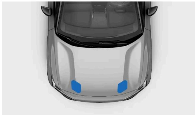
Drücken Sie die Frontklappe an der Vorderkante mit beiden Händen herunter. Kontrollieren Sie, dass die Sperrriegel der Frontklappe gleichzeitig einrasten. Halten Sie die Vorderkante beim Schließen gerade.
