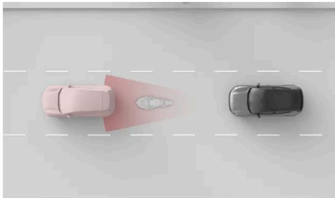
Das kleinere Motorrad und das Fahrzeug sind nahe beieinander und überlappen sich. Dadurch wird die Erkennung des Motorrads ungenauer.
