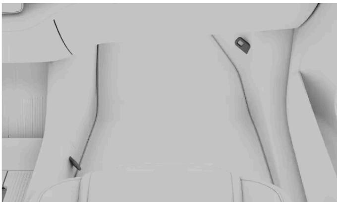
Bei Ausstattung mit dem Zubehör für den unteren Haltegurt<sup>[1]</sup> befinden sich die unteren Verankerungspunkte an den Seiten des Beifahrerfußraums.
