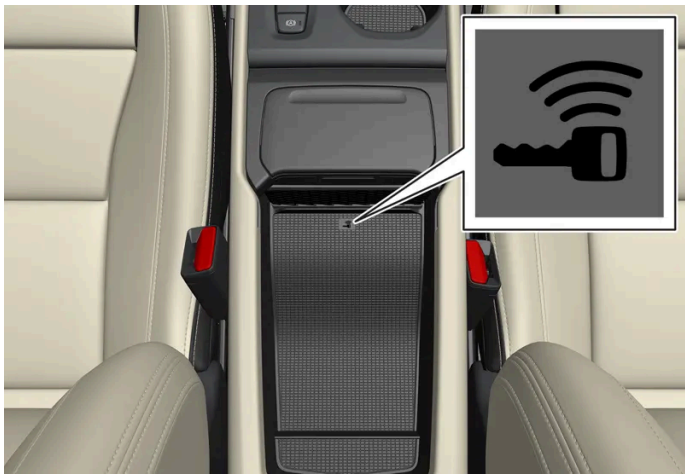
Lage des Schlüssellesegeräts an der Tunnelkonsole.
