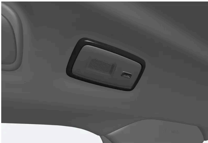
In Fahrzeugen mit Panoramadach* befinden sich die beiden Leuchteinheiten jeweils an der Seite des Daches.
