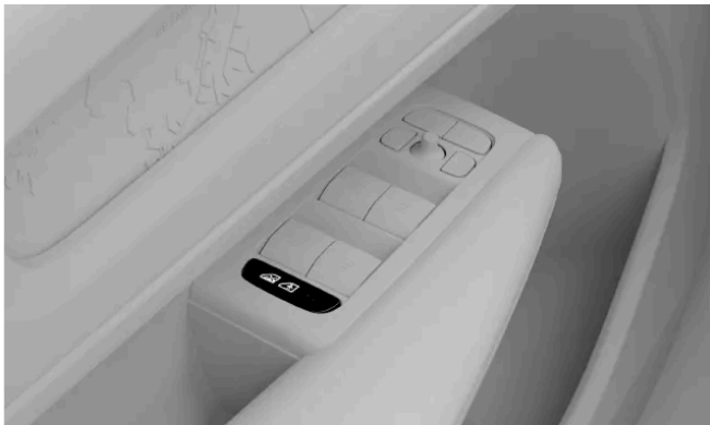
Position der Kindersicherungstaste in der Türverkleidung
