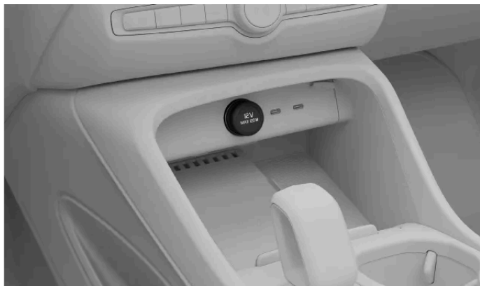
Die 12-V-Steckdose in der Tunnelkonsole
