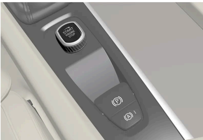
Startschalter auf der Tunnelkonsole.
