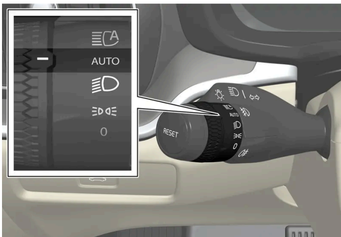
Drehring am Lenkradhebel in Stellung AUTO .
