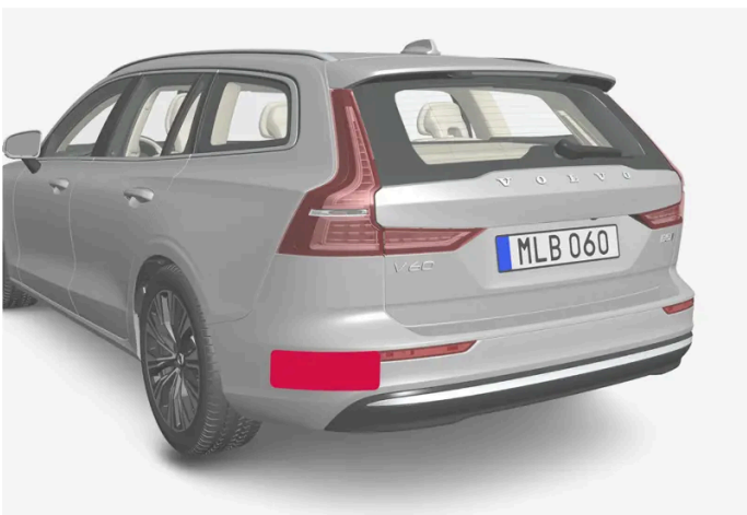
Lage der hinteren Radarmodule
