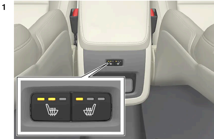
Tasten für die Sitzheizung hinten an der Tunnelkonsole.
