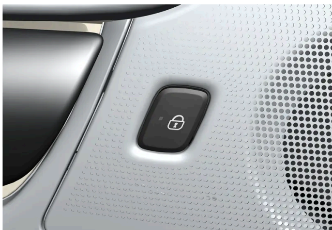
Verriegelungstaste mit Anzeigeleuchte an der Hintertür.
