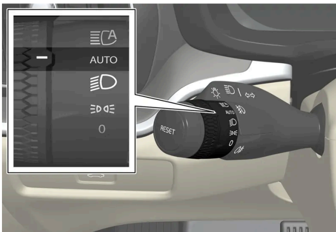
Drehring am Lenkradhebel in Stellung AUTO .
