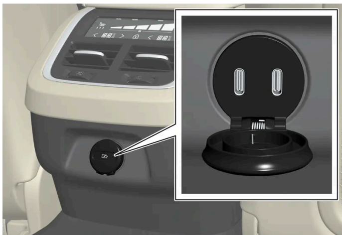
USB-Anschlüsse (Typ C) in der Tunnelkonsole, Fond.
