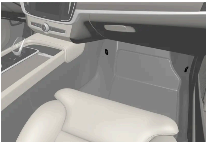
Lage der Befestigungspunkte für den Vordersitz
