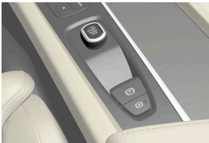
Startschalter auf der Tunnelkonsole.
