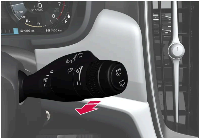
Waschfunktion, rechter Lenkradhebel.
