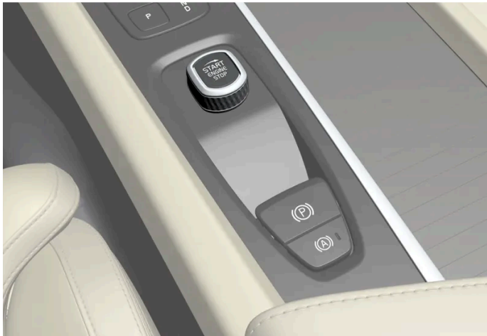
Startschalter auf der Tunnelkonsole.
