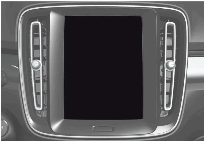
Home-Taste des Displays in der Mittelkonsole.
