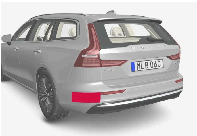
Platzierung der hinteren Radareinheiten
