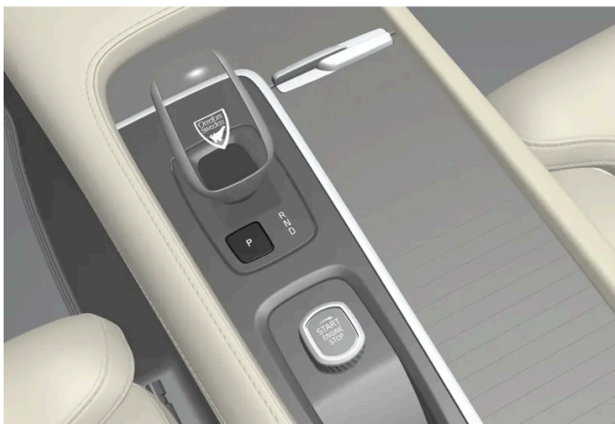
Übersicht über Wählhebel und Stellung P.
