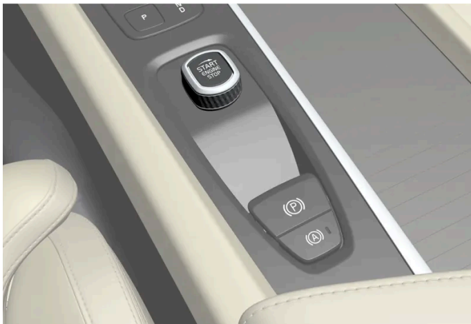
Startschalter auf der Tunnelkonsole.
