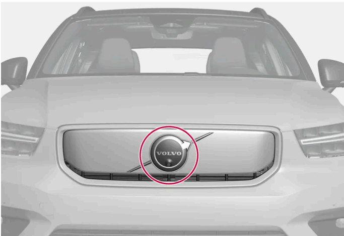
Lage des vorderen Radarmoduls
