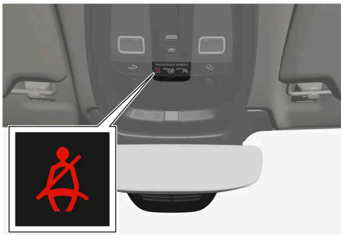
Leuchtanzeige in der Dachkonsole.
