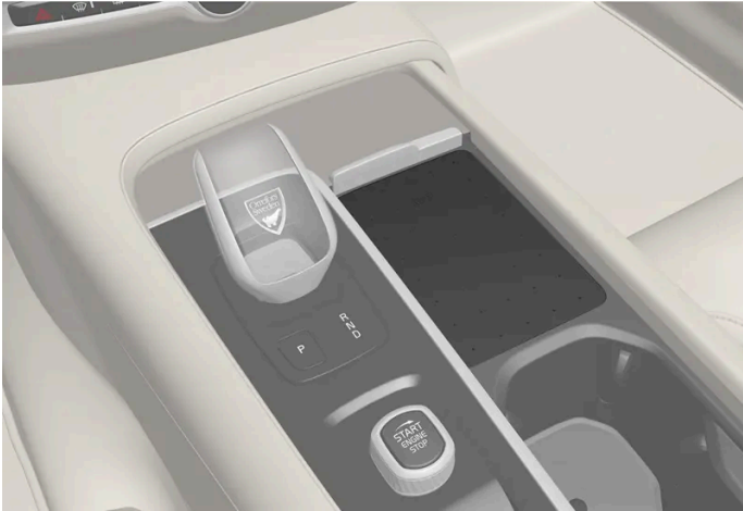
Induktives Ladesystem in der Tunnelkonsole.
