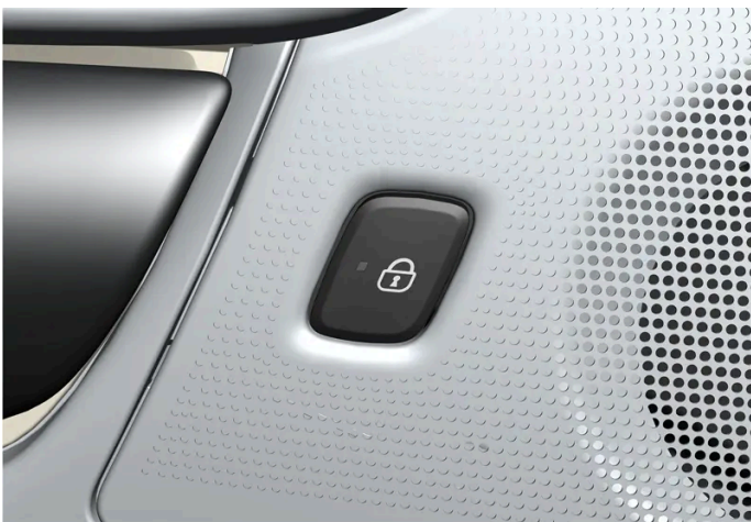
Verriegelungstaste mit Anzeigeleuchte an der Hintertür.
