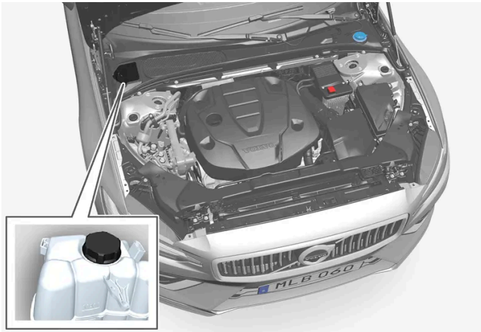
Ausgleichsbehälter für die Kühlanlage
