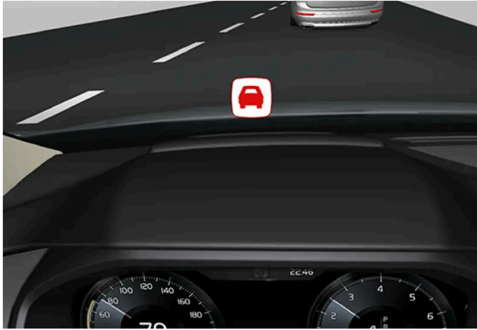
Symbol der Aufprallwarnung auf der Windschutzscheibe
