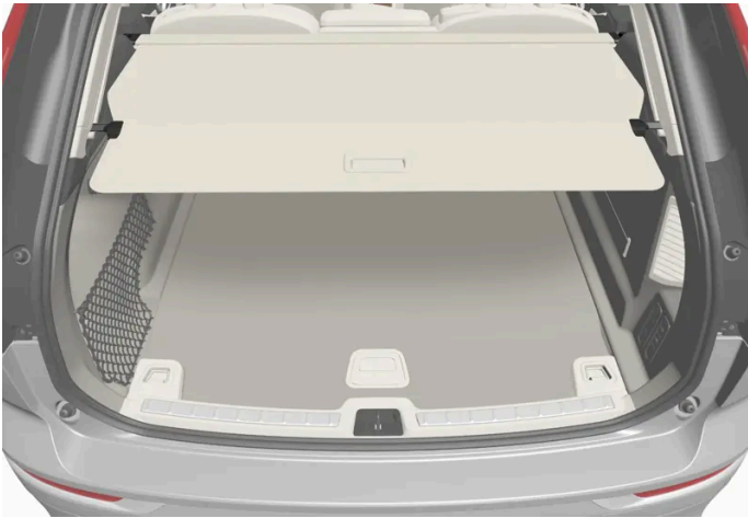
Die Abdeckung in der vollständig ausgezogenen Stellung.
