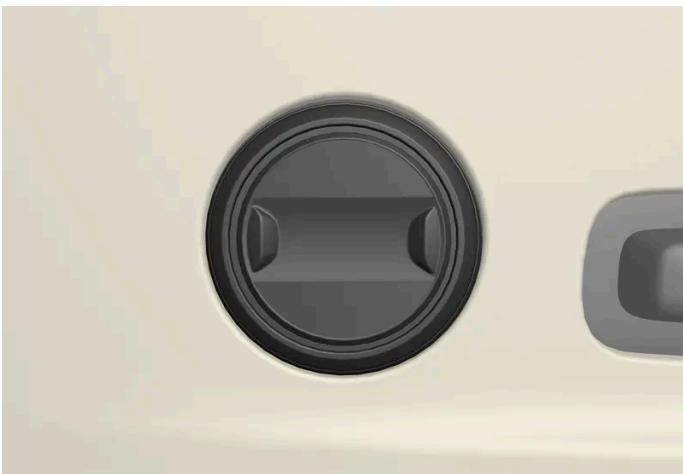
Bedienelement in Fahrzeugen mit Zwei-Wege-Lendenwirbelstütze*.
