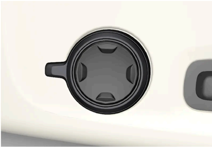
Multifunktionsschalter, in Fahrzeugen mit Vier-Wege-Lendenwirbelstütze*.
