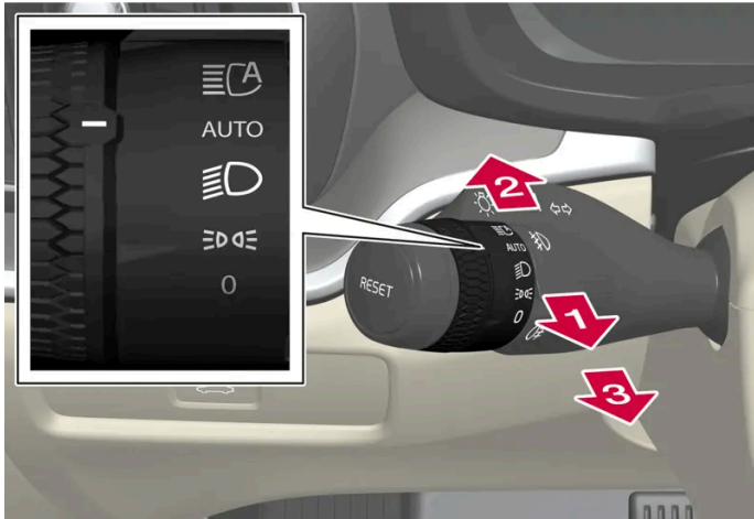
Lenkradhebel mit Drehring.
