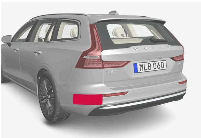
Platzierung der hinteren Radareinheiten
