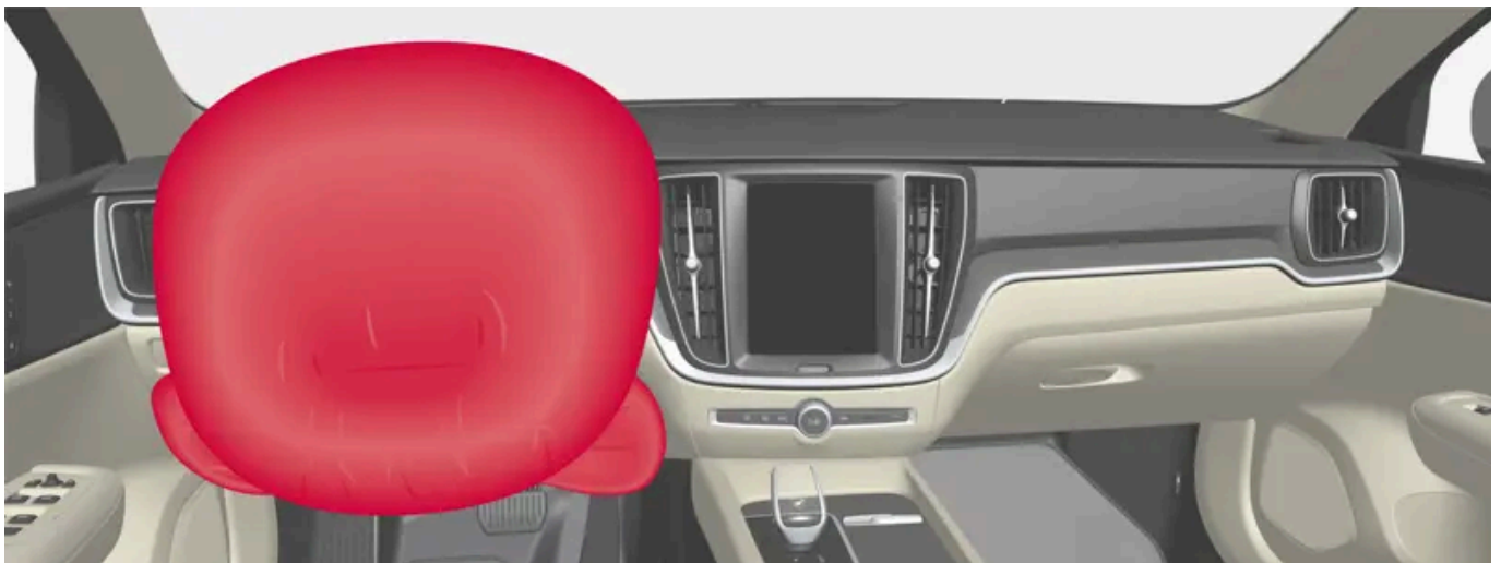
Lenkrad-Airbag und Knie-Airbag [1] am Fahrersitz.
