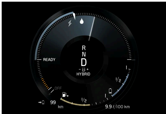
Fahrerdisplay bei Antrieb durch Elektro- und Verbrennungsmotor.
