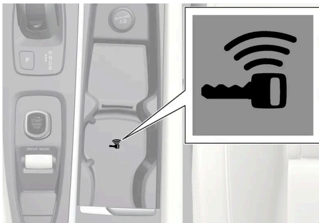
Lage des Schlüssellesegeräts in der Tunnelkonsole.
