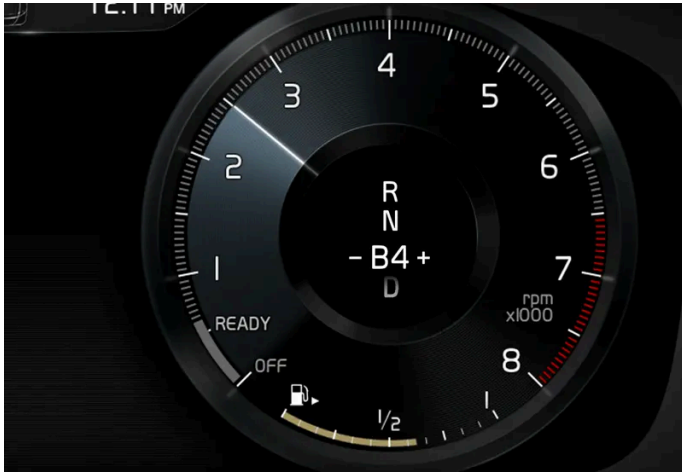
Fahrerdisplay beim Schalten mit Schaltwippen in der Schaltstellung für manuelles Schalten.
