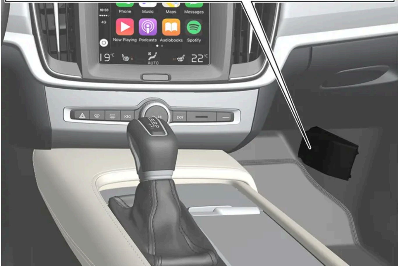
Der Sicherungskasten befindet sich hinter der Bodenmatte/Seitenverkleidung.
