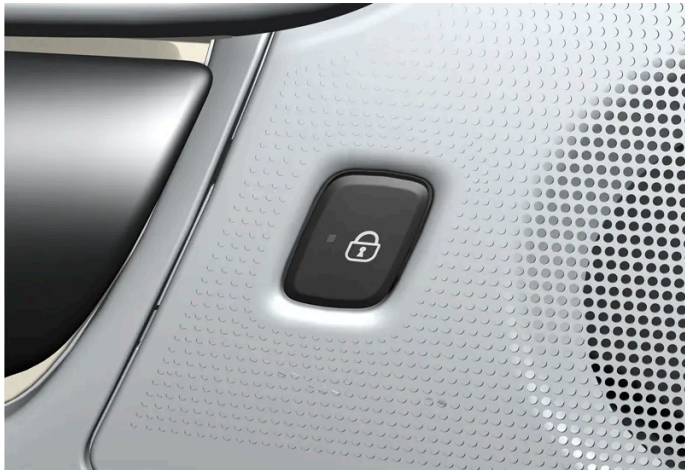
Verriegelungstaste mit Anzeigeleuchte an der Fondtür.
