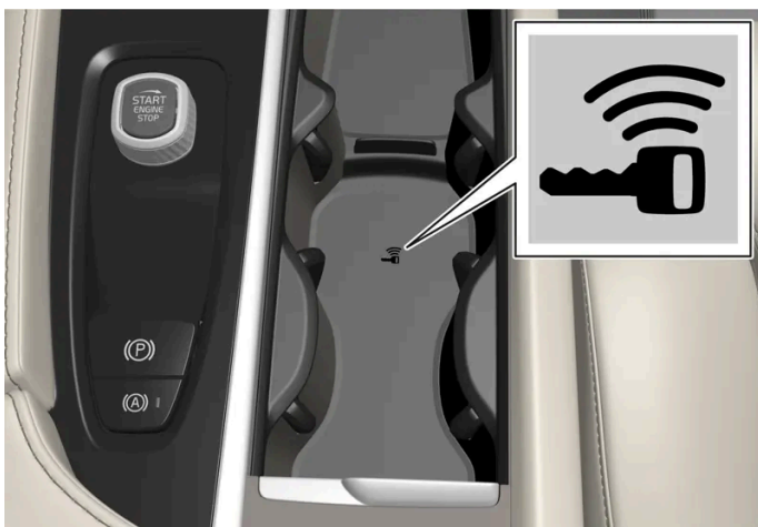
Lage des Schlüssellesegeräts in der Tunnelkonsole.
