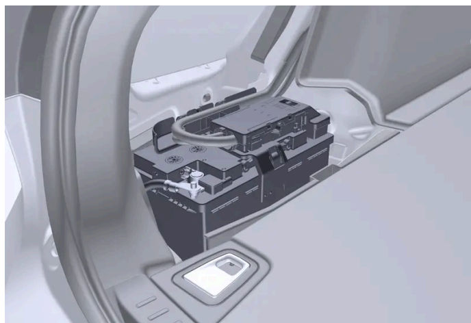
Die Startbatterie befindet sich im Kofferraum.
