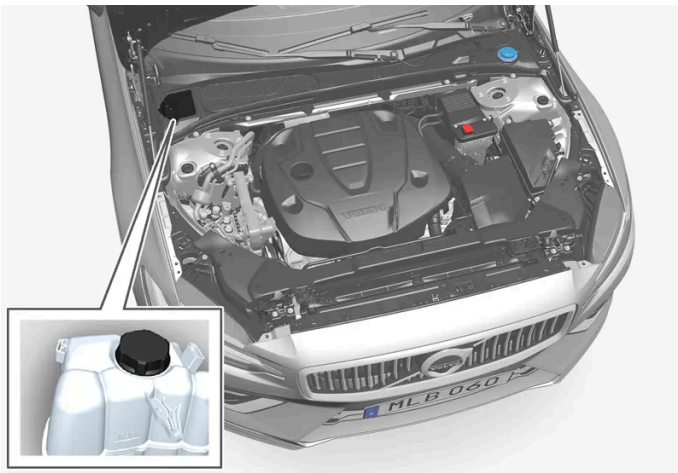
Ausgleichsbehälter für die Kühlanlage
