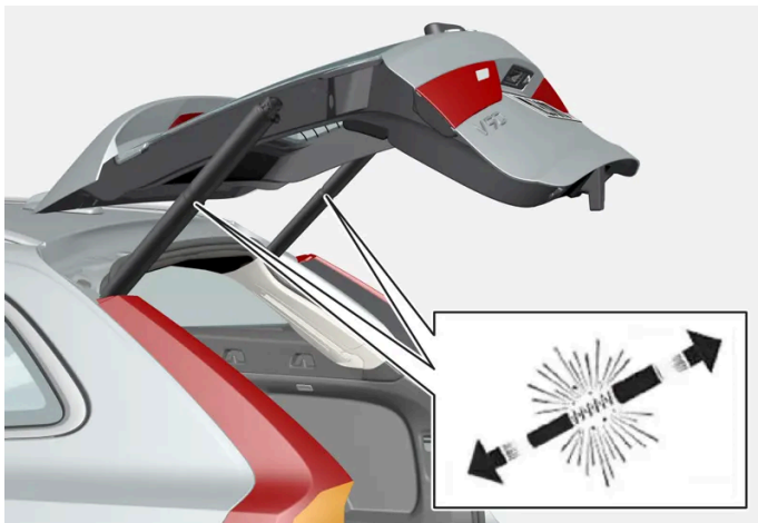
Vorgespannte Federn der elektrisch betätigten Heckklappe.
