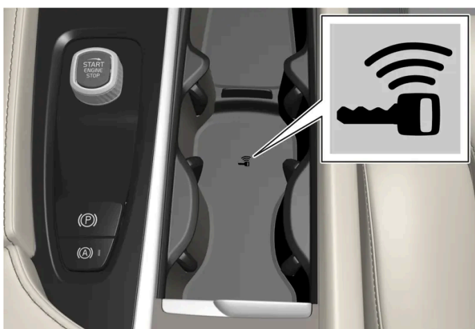
Lage des Schlüssellesegeräts in der Tunnelkonsole.
