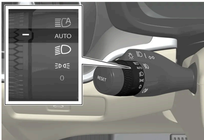
Drehring am Lenkradhebel in Stellung AUTO .
