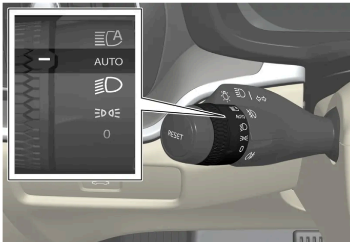
Drehring am Lenkradhebel in Stellung AUTO .
