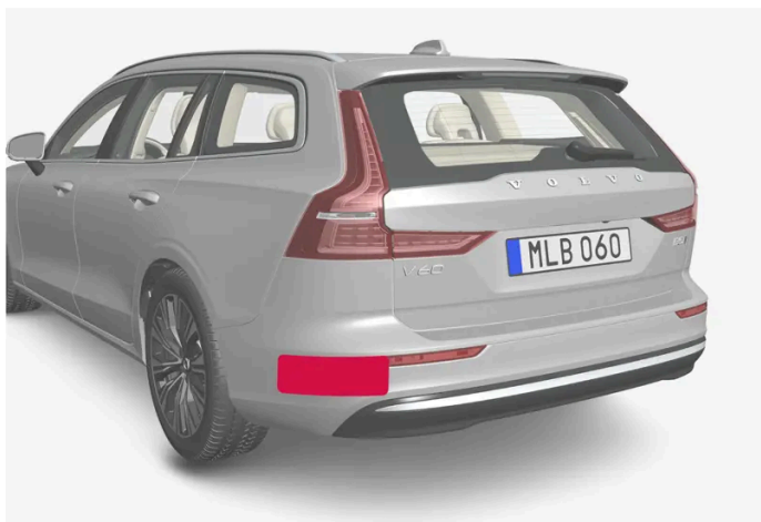
Lage der hinteren Radarmodule
