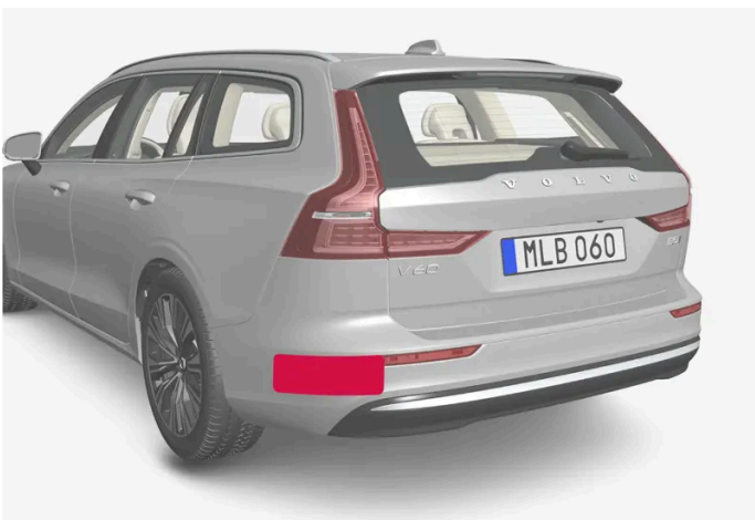
Platzierung der hinteren Radareinheiten
