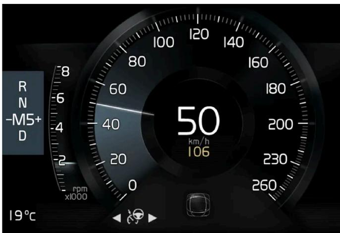
Schaltanzeige auf dem 8-Zoll-Fahrerdisplay bei kleinem Wählhebel.
