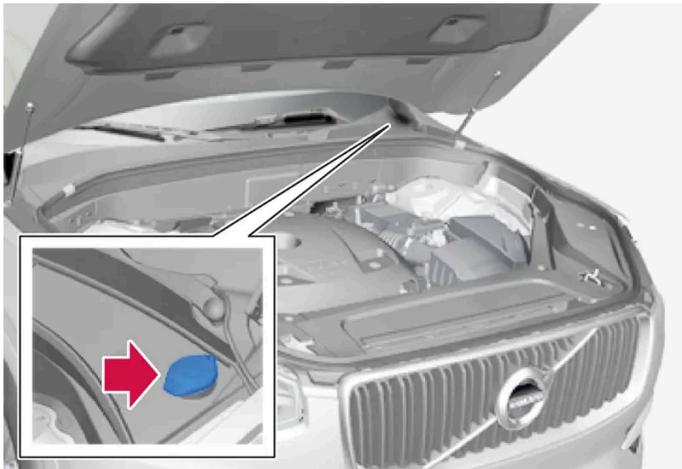
Scheibenreinigungsflüssigkeit wird in den Behälter mit blauem Deckel eingefüllt. Dieser Behälter enthält den Scheibenreiniger für Windschutzscheibe, Heckscheibe und Scheinwerfer\*.
