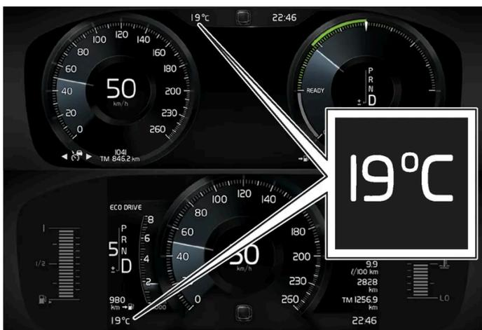
Lage des Außentemperaturmessers auf dem 12-\* bzw. 8-Zoll-Fahrerdisplay. Die Abbildung ist thematisch - je nach Fahrzeugmodell können die Einzelheiten unterschiedlich sein.
