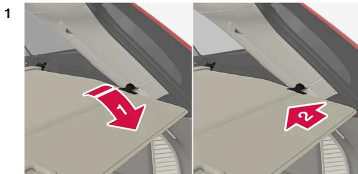
1 → Den Griff fassen und die Abdeckung vollständig herausziehen.
