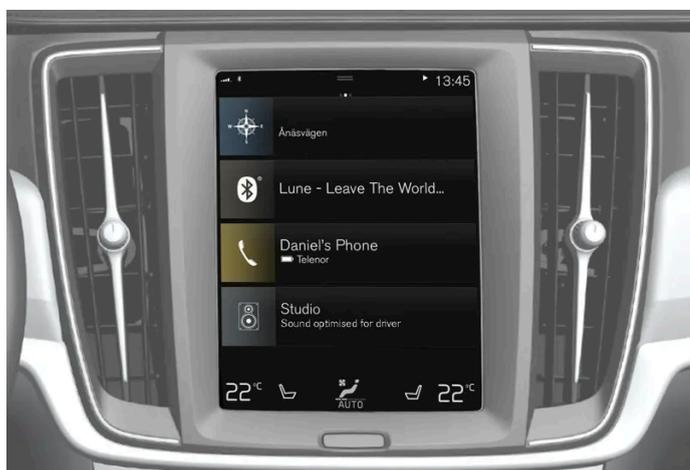
Viele der Hauptfunktionen des Fahrzeugs werden über das Display in der Mittelkonsole, einem berührungsempfindlichen Bildschirm (Touchscreen) gesteuert. Die Anzahl der physischen Tasten und Bedienelemente des Fahrzeugs ist deshalb minimal. Der Bildschirm kann mit oder ohne Handschuhe bedient werden.
