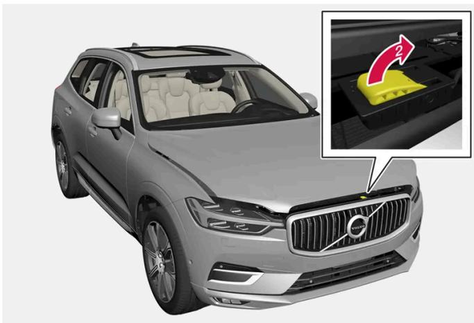
➔ Wenn Sie mit der Hand unter der Motorhaube von links nach rechts fahren, spüren Sie den Entriegelungsgriff. Führen Sie diesen zum Entriegeln der Motorhaube nach oben und zur Seite und heben Sie dann die Motorhaube an.
