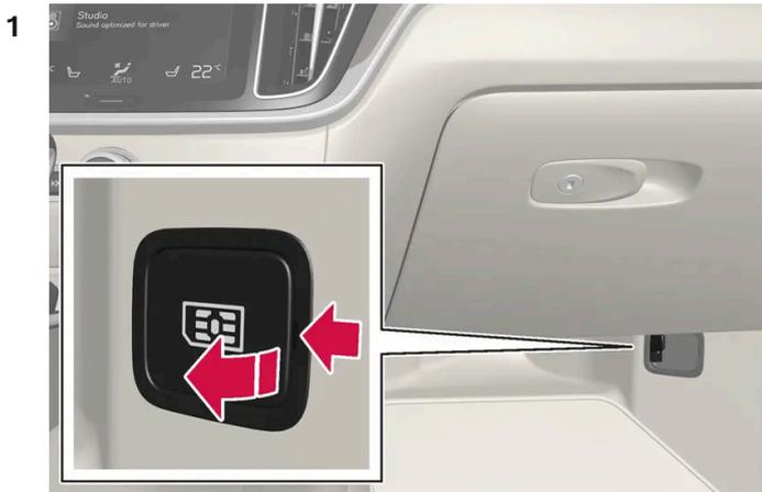
Setzen Sie Ihre SIM-Karte auf Beifahrerseite in die am Boden befindliche Halterung ein.
