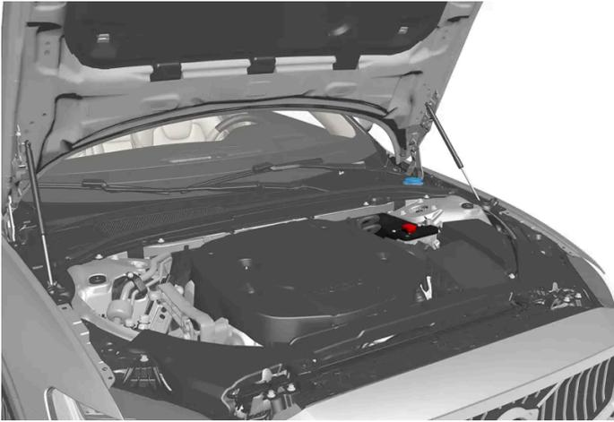
Die 12 V-Unterstützungsbatterie befindet sich im Motorraum.
