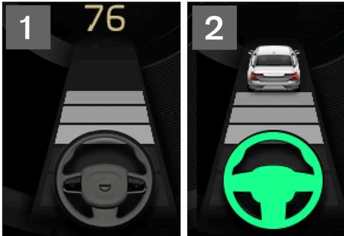
2 Wenn das Lenkradsymbol im Fahrerdisplay leuchtet, unterstützt Sie Pilot Assist beim Lenken.
