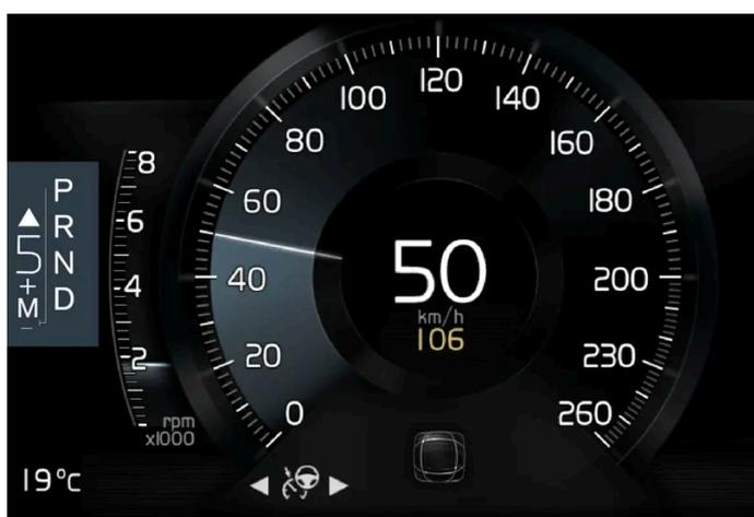
Schaltanzeige auf dem 8-Zoll-Fahrerdisplay bei großem Wählhebel.
