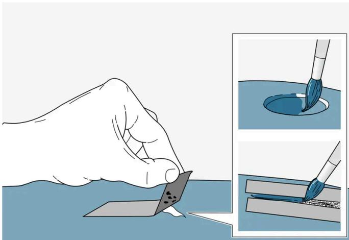
Wenn die Beschädigung nicht so tief ist, dass sie bis zum Metall reicht, kann der Korrekturlack direkt auf die gereinigte Oberfläche aufgebracht werden.
