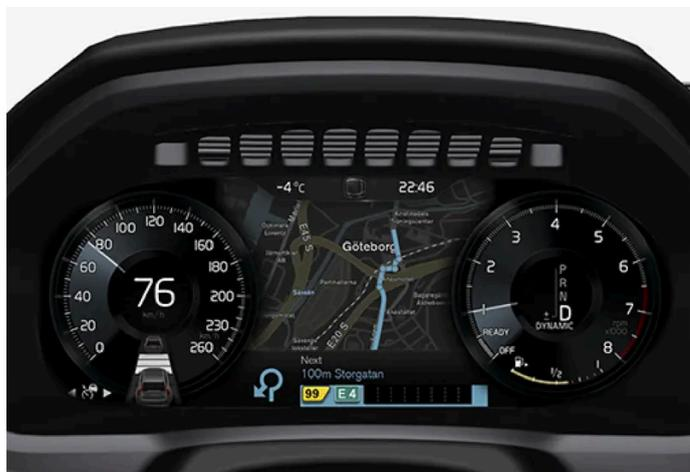
Die Karte wird nur bei Ausstattung des Fahrzeugs mit dem 12"-Fahrerdisplay angezeigt.
