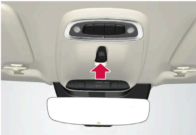
Das Panoramadach und die Sonnenblende werden mit einem Schalter an der Decke bedient.
