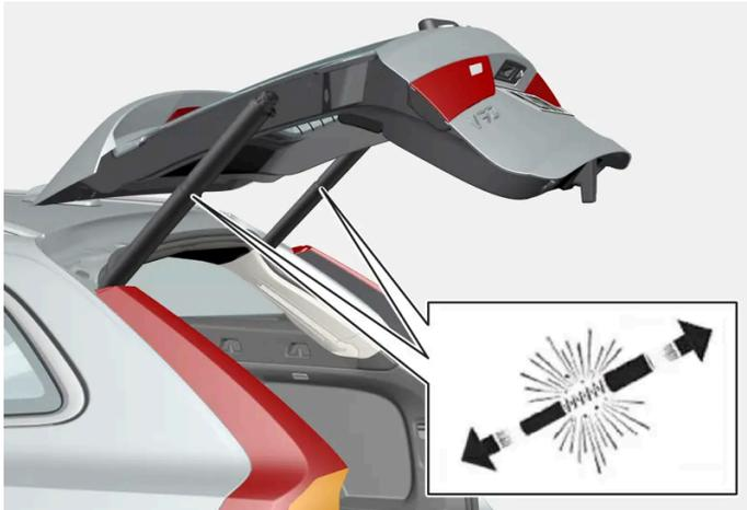
Vorgespannte Federn der elektrisch betätigten Heckklappe.
