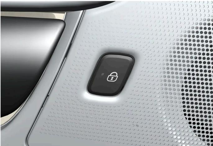
Verriegelungstaste mit Anzeigeleuchte an der Fondtür.
