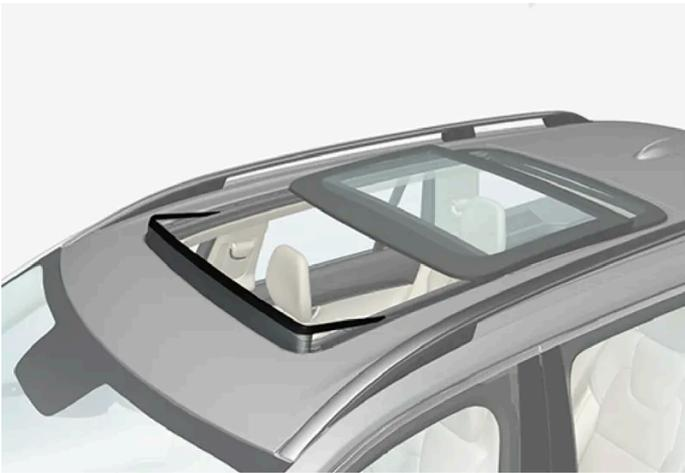
Zum Panoramadach gehört ein Windabweiser, der bei geöffnetem Panoramadach hochgeklappt wird.
