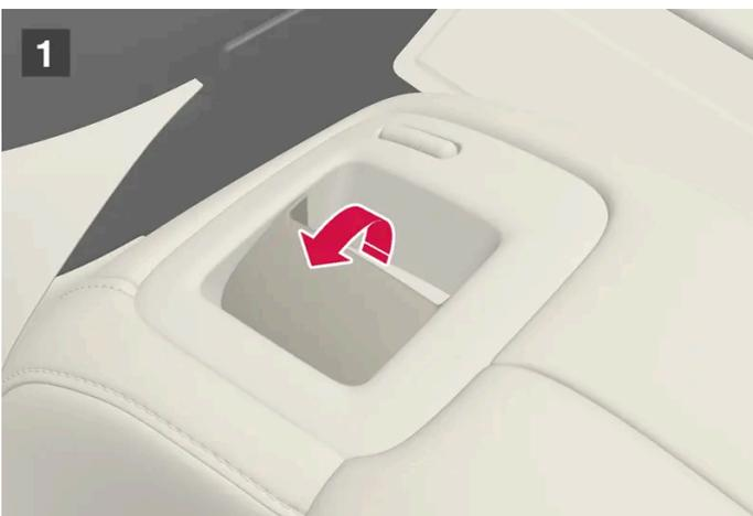
Bei Fahrzeugen mit elektrisch betätigtem\* Umklappen der Kopfstützen im Fond können die Kopfstützen der äußeren Sitze mit Hilfe der Handgriffe an der Oberseite der Sitze umgeklappt werden, siehe Abbildung **1**. Beachten Sie, dass hierdurch auch die
