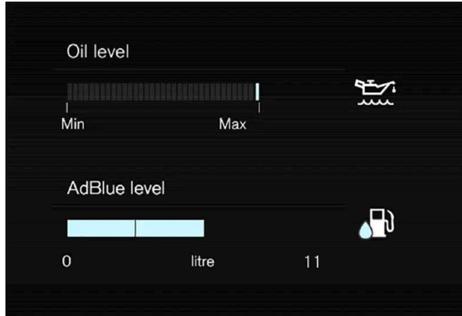
Darstellung für den AdBlue-Füllstand im Center Display.
