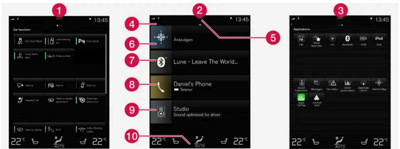
Drei der Hauptansichten des Displays in der Mittelkonsole. Streichen Sie nach rechts bzw. links über das Display, um zur Ansicht Funktionen bzw. Apps zu gelangen<sup>[1]</sup>.
