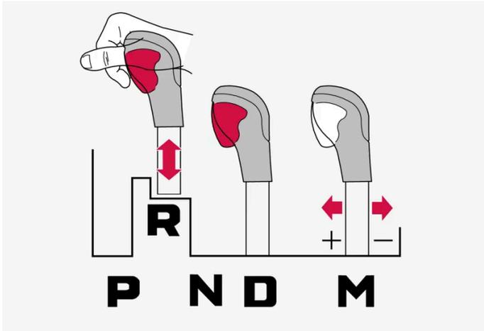
Wählhebelsperre für Fahrzeuge mit großem Wählhebel.
