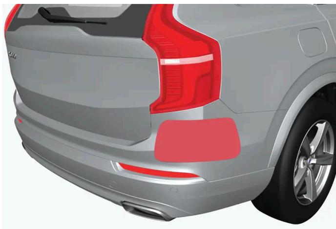
Platzierung der hinteren Radareinheiten
