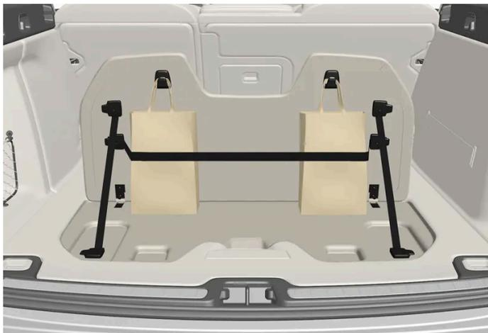
Im Deckel der Bodenklappe befinden sich zwei Taschenhaken und ein elastisches Spannband<sup>[1]</sup>. Das Band lässt sich in vier Lagen befestigen.
