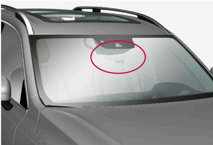
Anordnung der vorderen Kamera- und Radareinheit
