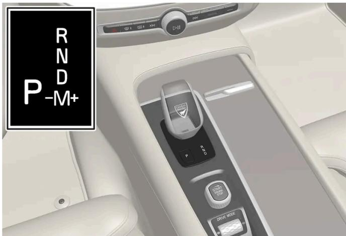
Kleiner Wählhebel und Schaltmuster auf dem Fahrerdisplay.
