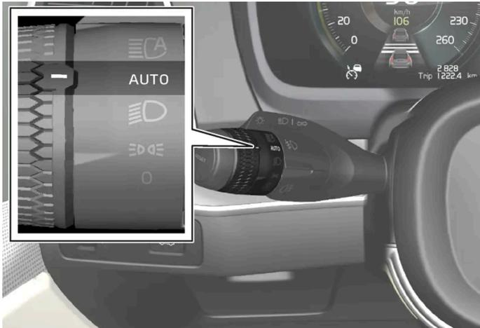
Drehring am Lenkradhebel in Stellung **AUTO**.
