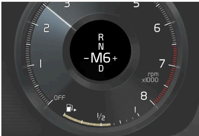
Schaltanzeige auf dem 12-Zoll-Fahrerdisplay bei kleinem Wählhebel\*.
