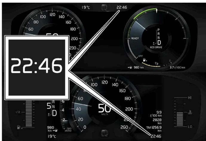
Lage der Uhr auf dem 12-Zoll-\* bzw. 8-Zoll-Fahrerdisplay. Die Abbildung ist thematisch - je nach Fahrzeugmodell können die Einzelheiten unterschiedlich sein.
