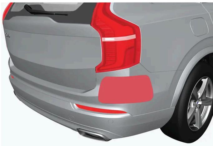
Platzierung der hinteren Radareinheiten
