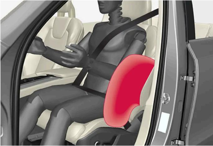
Die Seitenairbags sind im Außenrahmen der Rückenlehnen montiert und helfen, Fahrer und Beifahrer in den Vordersitzen zu schützen.
