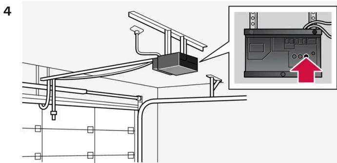
Finden Sie die Anlerntaste<sup>[2]</sup> am Empfänger, z. B. Garagentor. Die Platzierung ist normalerweise in der Nähe der Antennenfassung am Empfänger.
