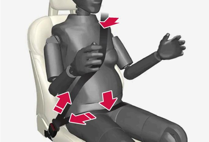
Der Sicherheitsgurt muss dicht an der Schulter anliegen, der Diagonalteil des Sicherheitsgurtes muss zwischen den Brüsten zur Seite des Bauches geführt werden.
