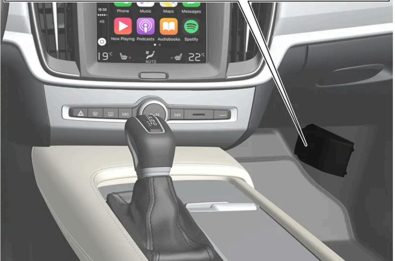
Der Sicherungskasten befindet hinter der Bodenmatte/Seitenverkleidung.
