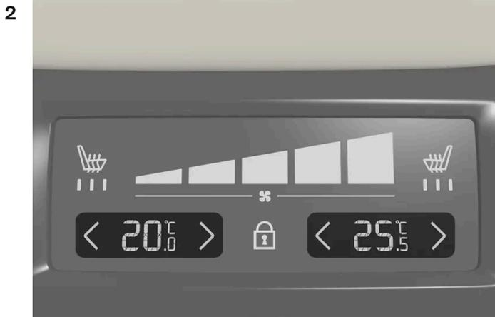
Temperaturregler auf dem hinteren Klima-Bedienfeld an der Tunnelkonsole.
