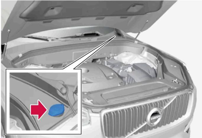
Scheibenreinigungsflüssigkeit wird in den Behälter mit blauem Deckel eingefüllt. Dieser Behälter enthält den Scheibenreiniger für Windschutzscheibe, Heckscheibe und Scheinwerfer\*.
