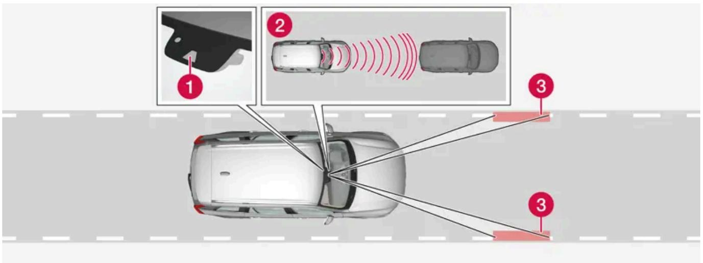
Die Kamera- und Radarsensoren messen den Abstand zum vorausfahrenden Fahrzeug und erkennen seitliche Fahrbahnmarkierungen.
