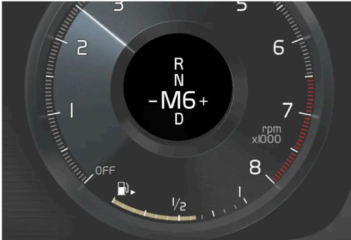
Schaltmuster auf dem Fahrerdisplay bei kleinem Wählhebel.
