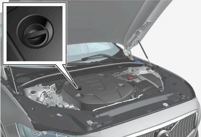
Einfüllrohr <sup>[1]</sup>, <sup>[2]</sup>
