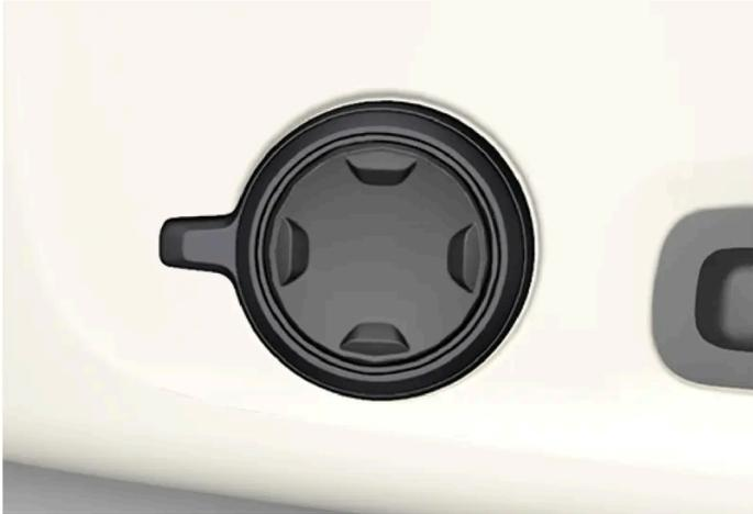
Multifunktionsschalter, in Fahrzeugen mit Vier-Wege-Lendenwirbelstütze\*.
