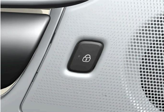
Verriegelungstaste mit Anzeigeleuchte an der Hintertür.
