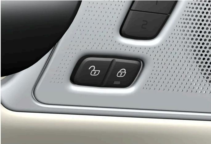
Verriegelungstasten mit Anzeigeleuchte an der Vordertür.
