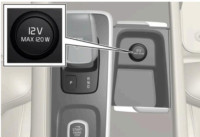
Vordere Steckdose auf der Tunnelkonsole bei Fahrzeugen ohne Drahtlos-Telefonladegerät\*.
