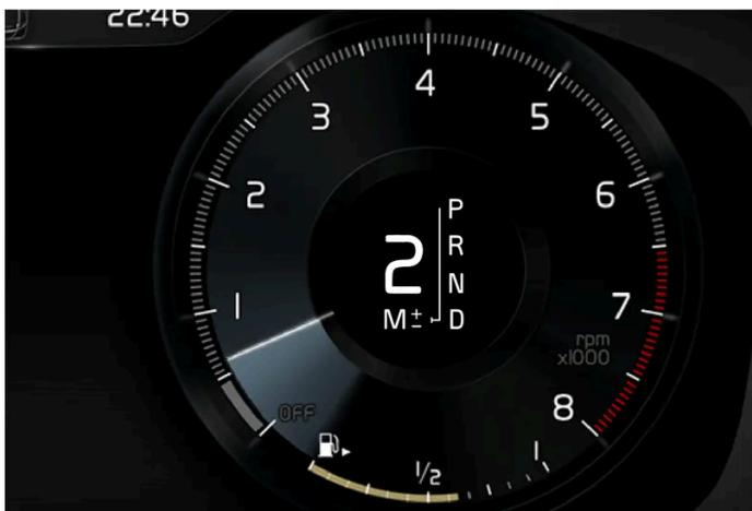
Schaltmuster auf dem Fahrerdisplay bei großem Wählhebel.
