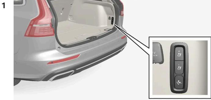
Öffnen Sie die Heckklappe. An der rechten Kofferraumwand befindet sich ein Schalter zum Ein- und Ausklappen der Anhängerkupplung. Damit die Anhängerkupplung ausgeklappt werden kann, muss die Anzeigeleuchte des Schalters orange leuchten.
