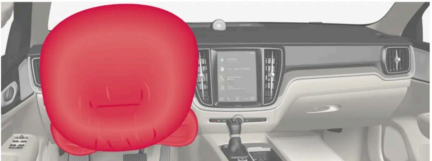
Lenkrad-Airbag und Knie-Airbag<sup>[1]</sup> am Fahrersitz.
