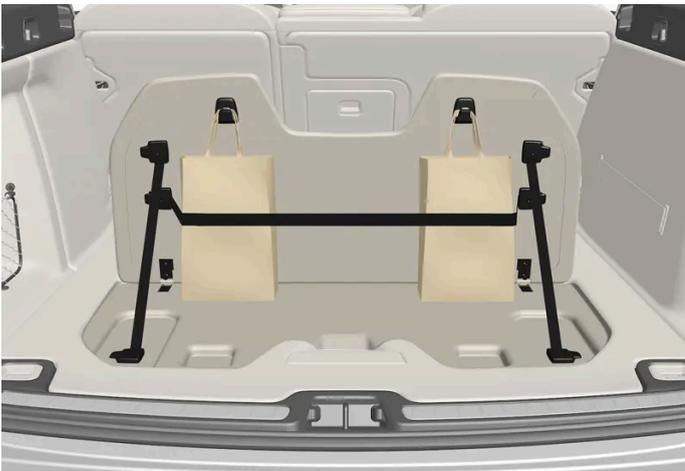
Im Deckel der Bodenklappe befinden sich zwei Taschenhaken und ein elastisches Spannband<sup>[1]</sup>. Das Band lässt sich in vier Lagen befestigen.
