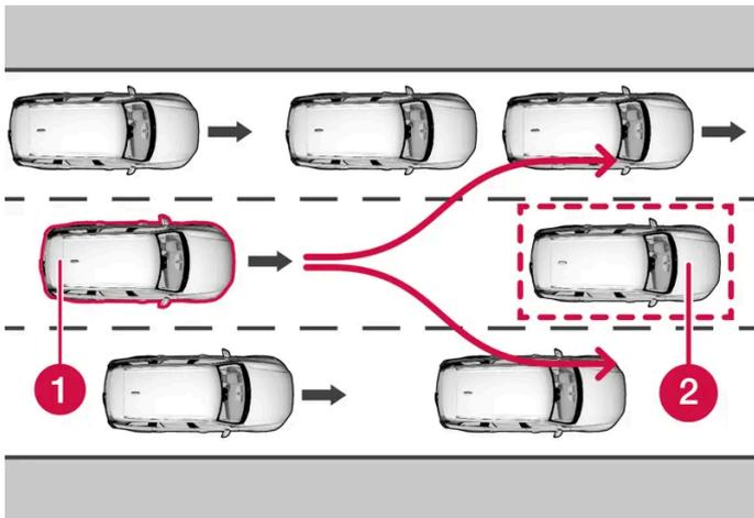
Das eigene Fahrzeug (1) „erkennt“ keine Möglichkeit, dem vorausfahrenden Fahrzeug (2) auszuweichen und wird daher ggf. schon früher automatisch abgebremst.
