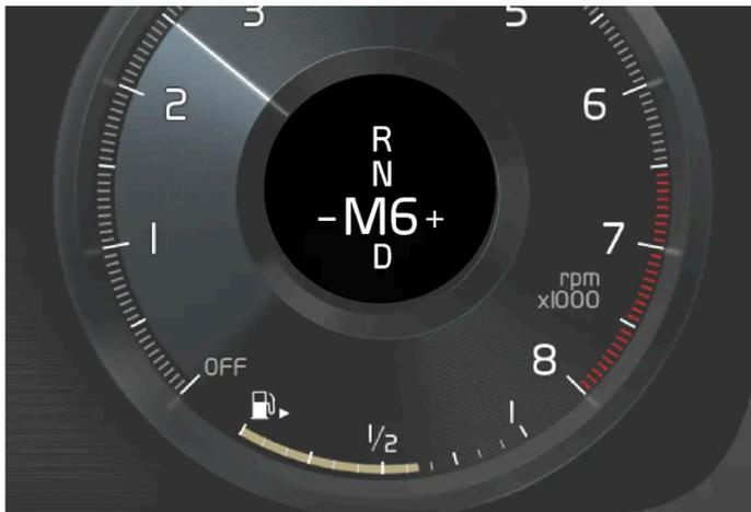
Schaltanzeige auf dem 12-Zoll-Fahrerdisplay bei kleinem Wählhebel\*.
