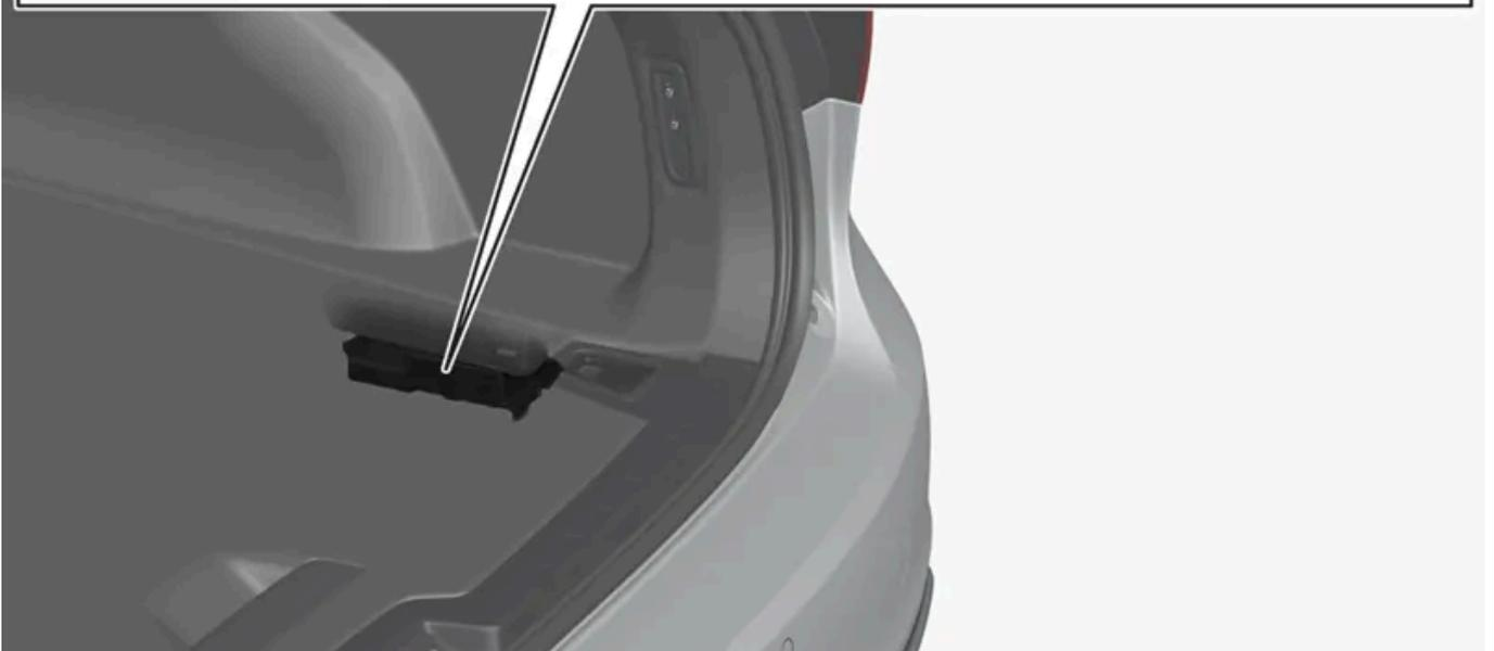
Der Sicherungskasten befindet sich rechts hinter der Verkleidung.
