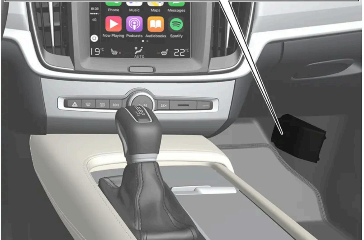
Der Sicherungskasten befindet hinter der Bodenmatte/Seitenverkleidung.
