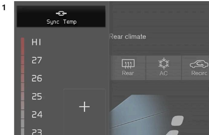
Synchronisierungstaste für den Temperaturregler der Fahrerseite.
