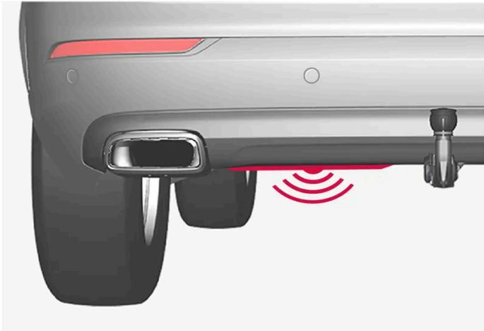
Der Sensor befindet sich etwas links von der Mitte des Stoßfängers.
