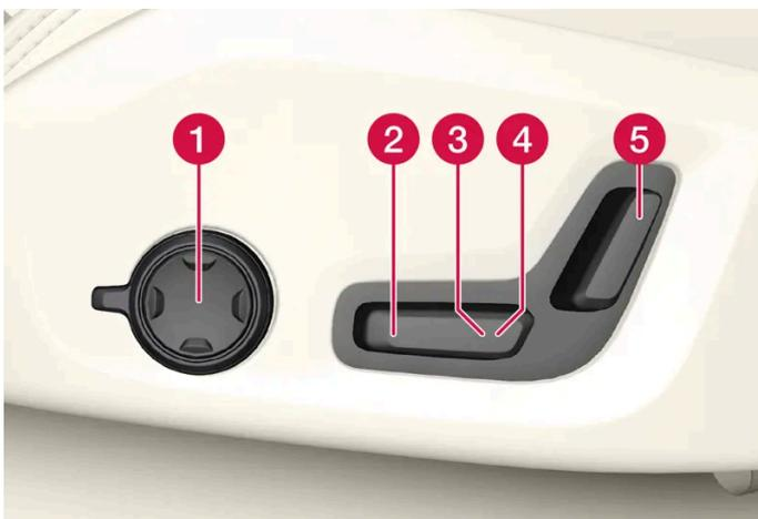
Die Abbildung zeigt die Bedienelemente eines Fahrzeugs mit Vier-Wege-Lendenwirbelstütze\*. Fahrzeuge mit Zwei-Wege-Lendenwirbelstütze\* verfügen nicht über den Multifunktionsdreheschalter.
