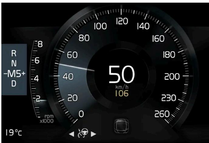
Schaltanzeige auf dem 8-Zoll-Fahrerdisplay bei kleinem Wählhebel.
