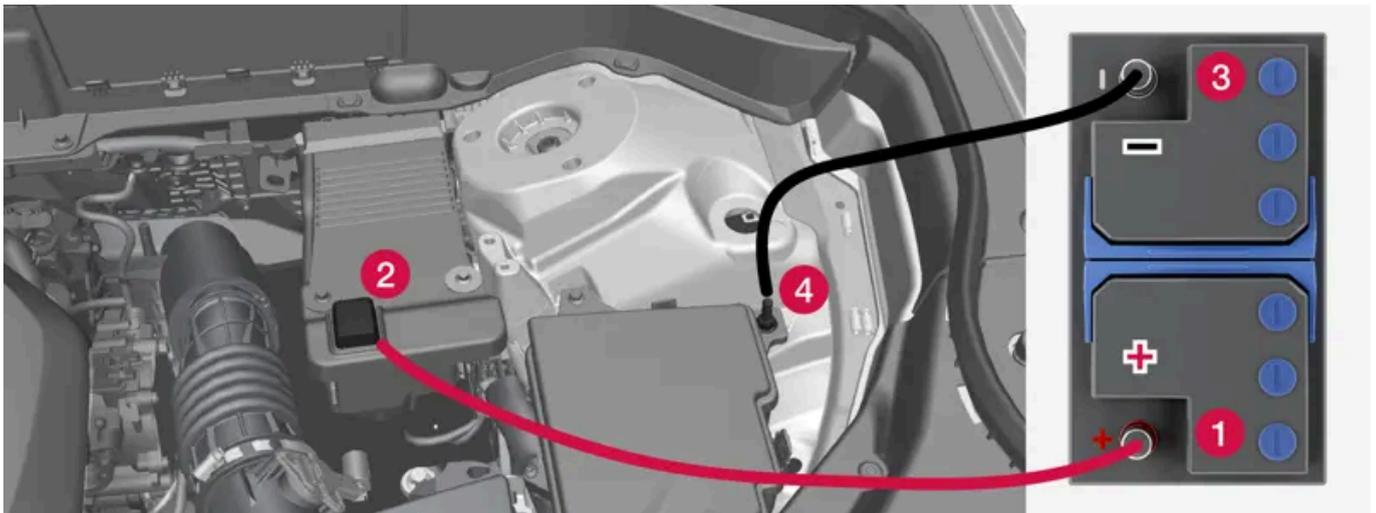
Anschlusspunkte der Starthilfekabel. Das Aussehen im Motorraum kann je nach Modell und Ausstattung variieren.
