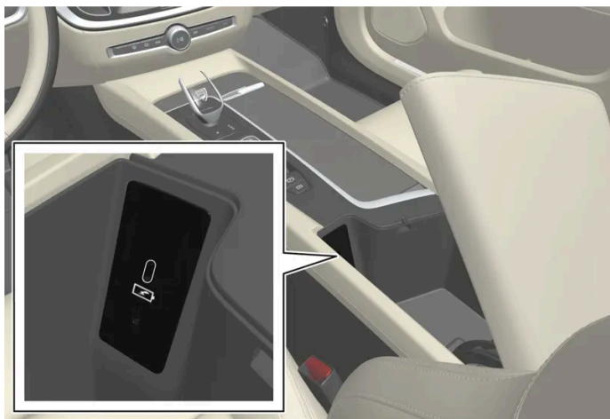
USB-Anschlüsse (Typ C), Vordersitz.
