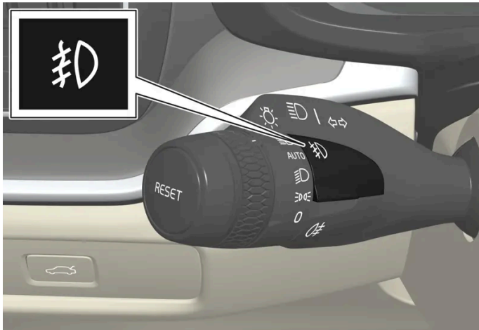
Taste für Nebelscheinwerfer.
