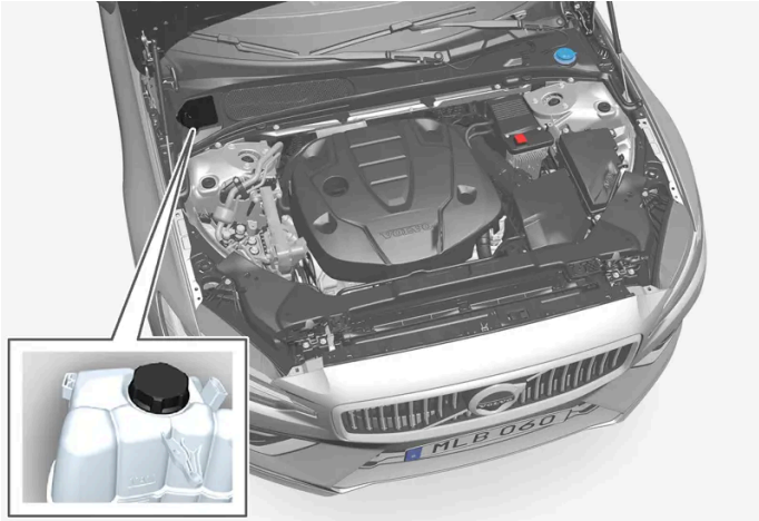
Ausgleichsbehälter für die Kühlanlage
