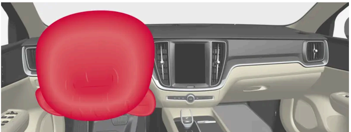
Lenkrad-Airbag und Knie-Airbag [1] am Fahrersitz.
