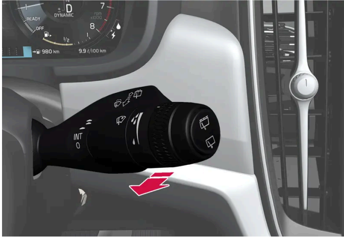
Waschfunktion, rechter Lenkradhebel.
