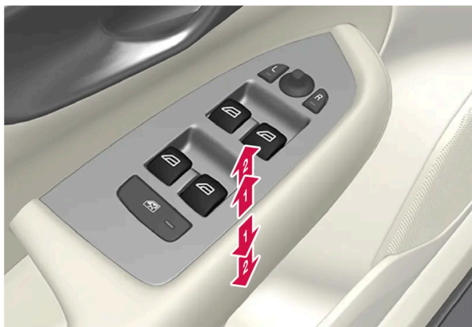
Betätigung der Fensterheber.
