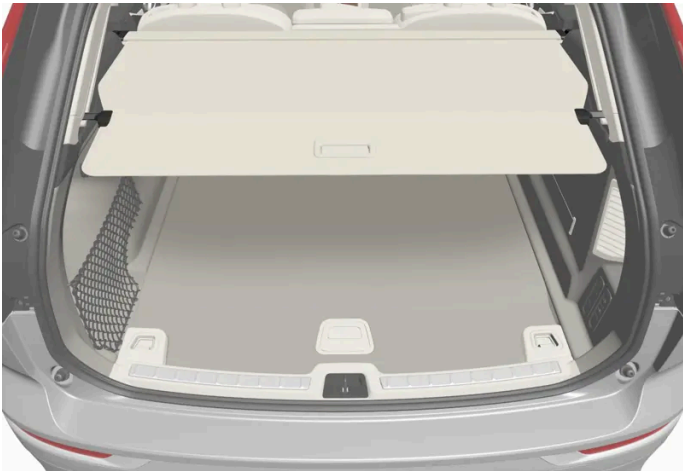
Die Abdeckung in der vollständig ausgezogenen Stellung.
