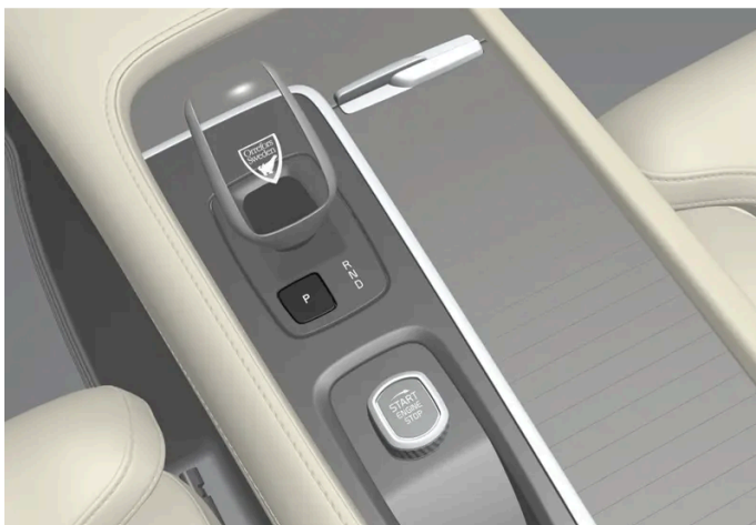
Übersicht über Wählhebel und Stellung P.
