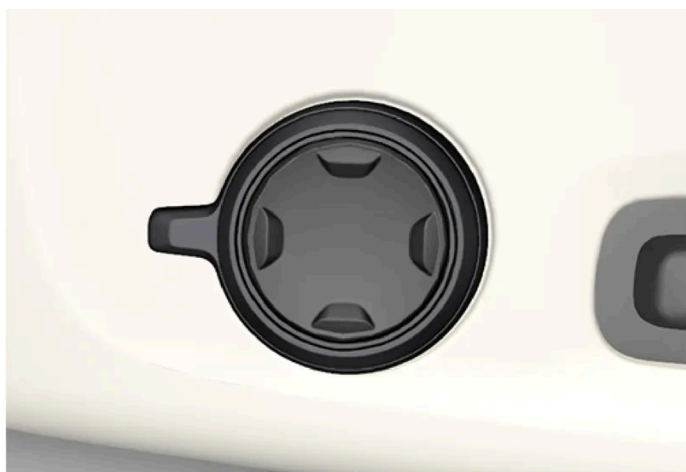
Seitlich am Sitzpolster angebrachter Multifunktionsschalter.
