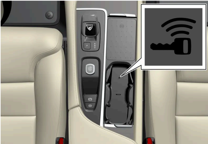
Lage des Schlüssellesegeräts an der Tunnelkonsole.
