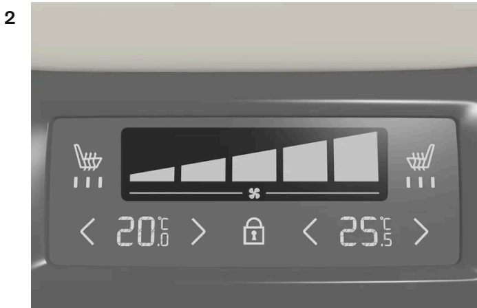
Gebläseregler auf dem hinteren Klima-Bedienfeld an der Tunnelkonsole.
