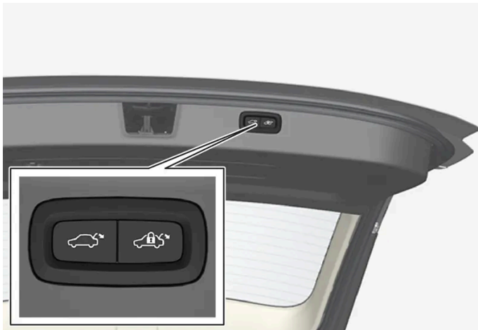
Lage der Taste(n) an der Unterseite der Heckklappe.
