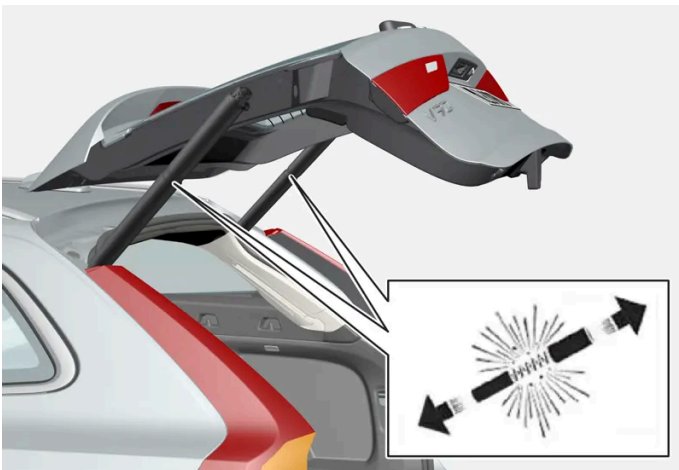
Vorgespannte Federn der elektrisch betätigten Heckklappe.
