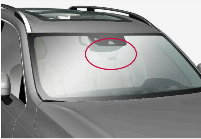
Lage des vorderen Kameramoduls
