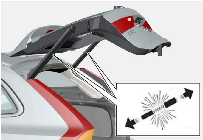
Vorgespannte Federn der elektrisch betätigten Heckklappe.
