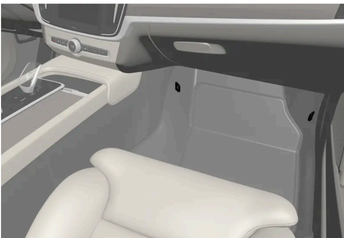
Lage der Befestigungspunkte für den Vordersitz
