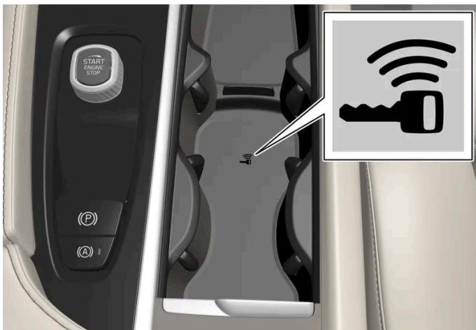
Lage des Schlüssellesegeräts in der Tunnelkonsole.
