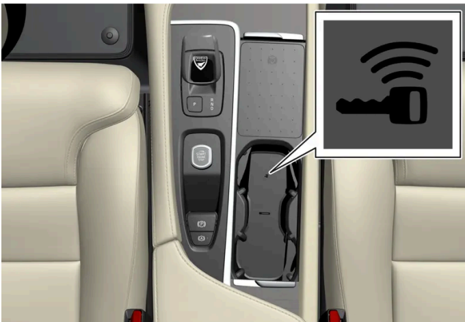
Lage des Schlüssellesegeräts an der Tunnelkonsole.
