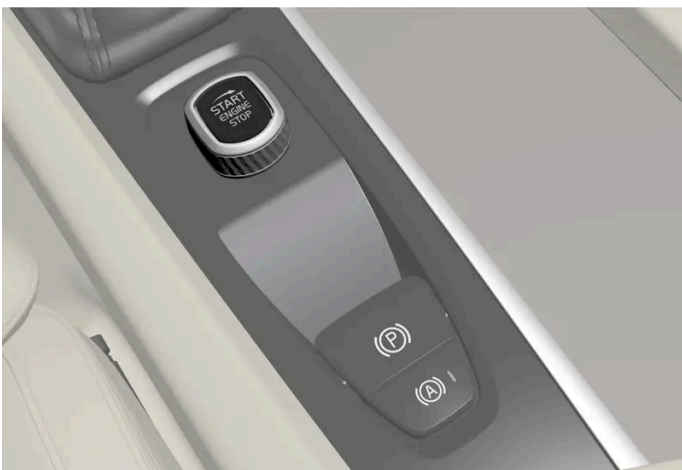
Startschalter auf der Tunnelkonsole.
