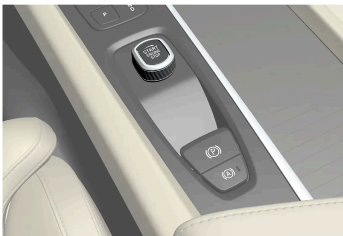
Startschalter auf der Tunnelkonsole.
