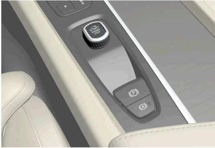
Startschalter auf der Tunnelkonsole.
