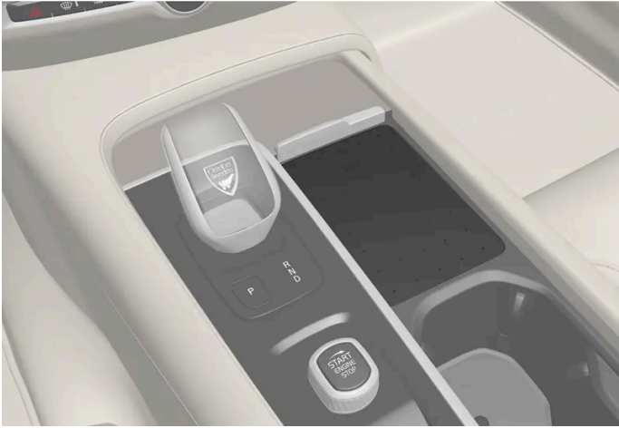
Induktives Ladesystem in der Tunnelkonsole.
