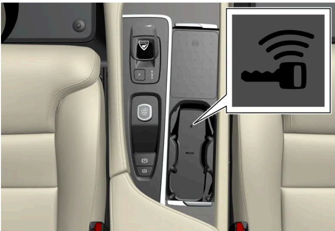
Lage des Schlüssellesegeräts an der Tunnelkonsole.
