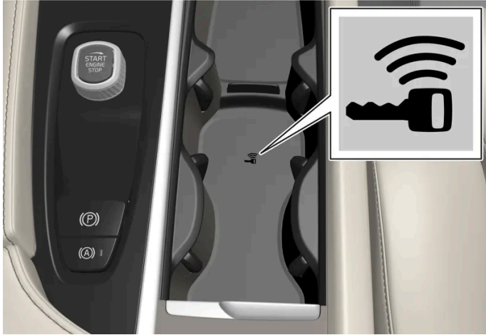
Lage des Schlüssellesegeräts in der Tunnelkonsole.
