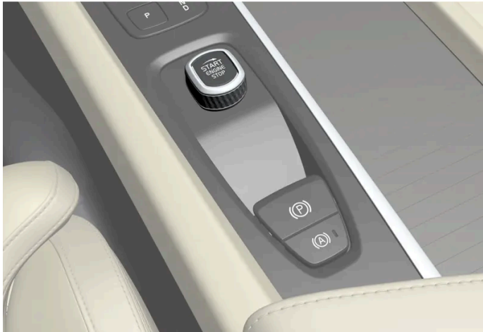
Startschalter auf der Tunnelkonsole.
