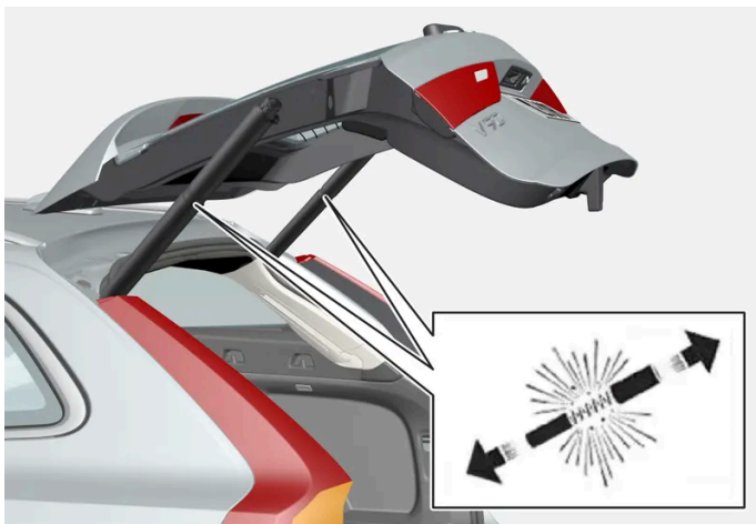
Vorgespannte Federn der elektrisch betätigten Heckklappe.
