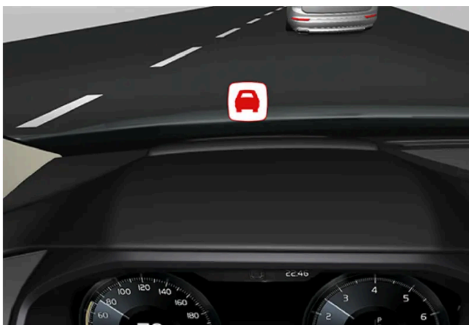
Symbol der Aufprallwarnung auf der Windschutzscheibe
