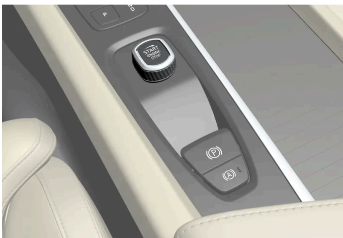
Startschalter auf der Tunnelkonsole.
