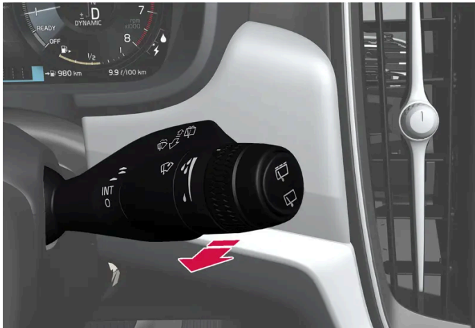
Waschfunktion, rechter Lenkradhebel.
