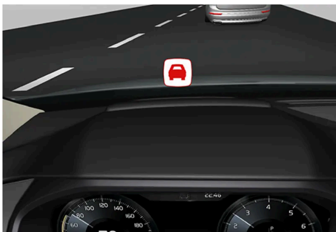
Symbol der Aufprallwarnung auf der Windschutzscheibe
