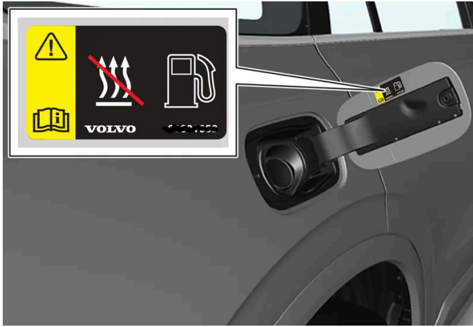
Warnaufkleber auf der Kraftstofftankklappe.
