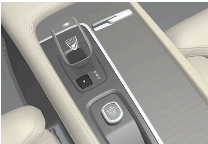
Übersicht über Wählhebel und Stellung P.
