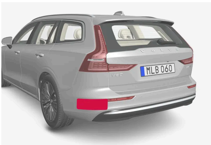
Lage der hinteren Radarmodule
