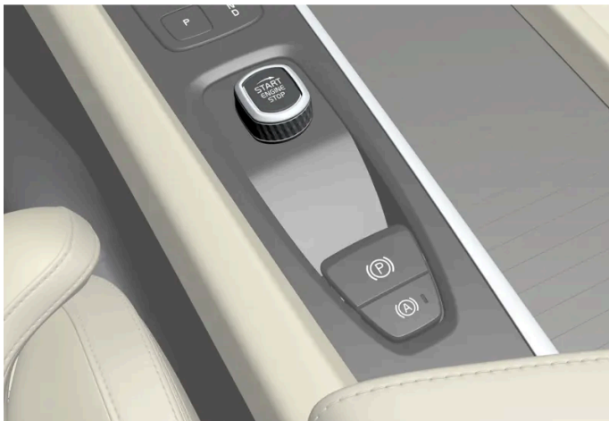
Startschalter auf der Tunnelkonsole.
