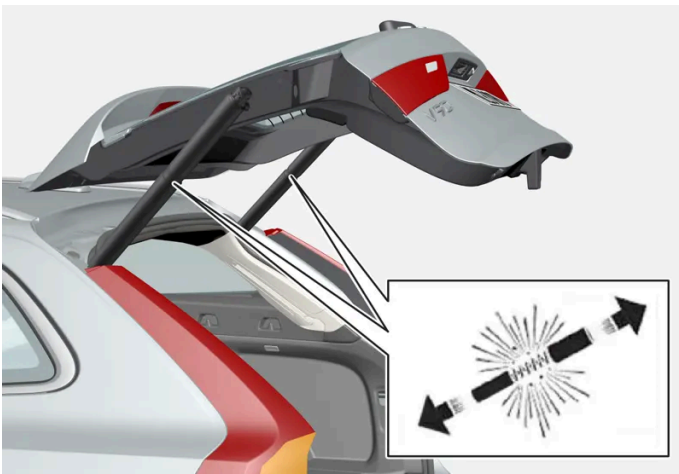
Vorgespannte Federn der elektrisch betätigten Heckklappe.
