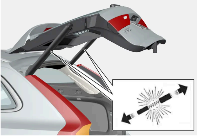
Vorgespannte Federn der elektrisch betätigten Heckklappe.
