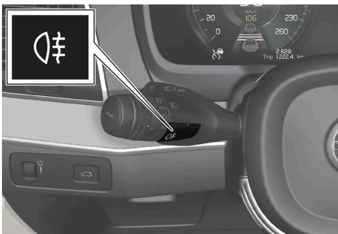
Taste für Nebelschlussleuchte.
