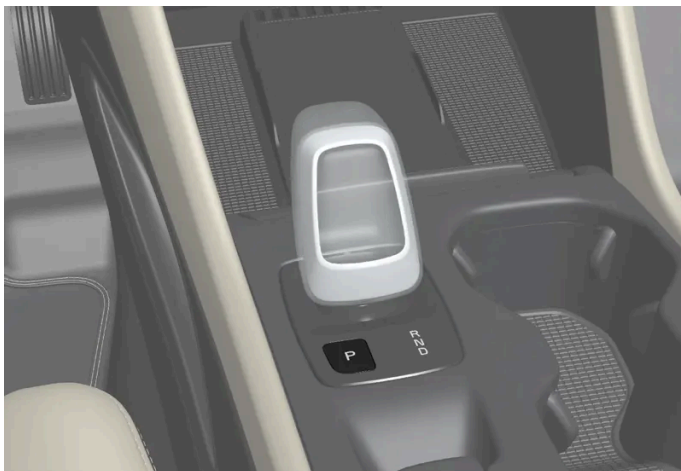
Übersicht über Wählhebel und Stellung P
