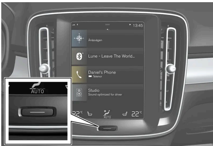
Home-Taste des Displays in der Mittelkonsole.
