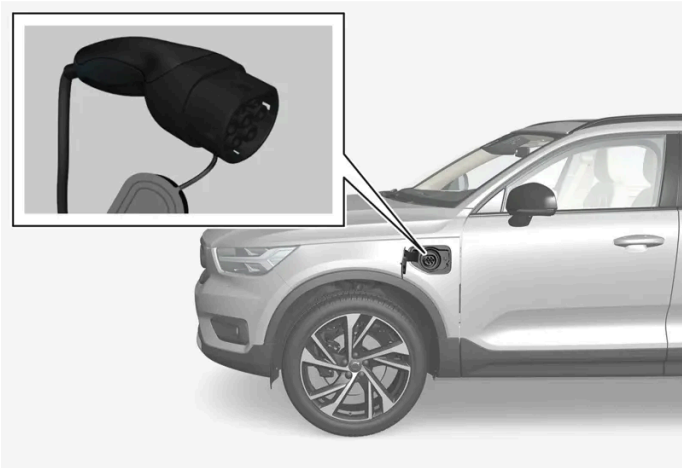
Ladestutzen und Ladebuchse.
