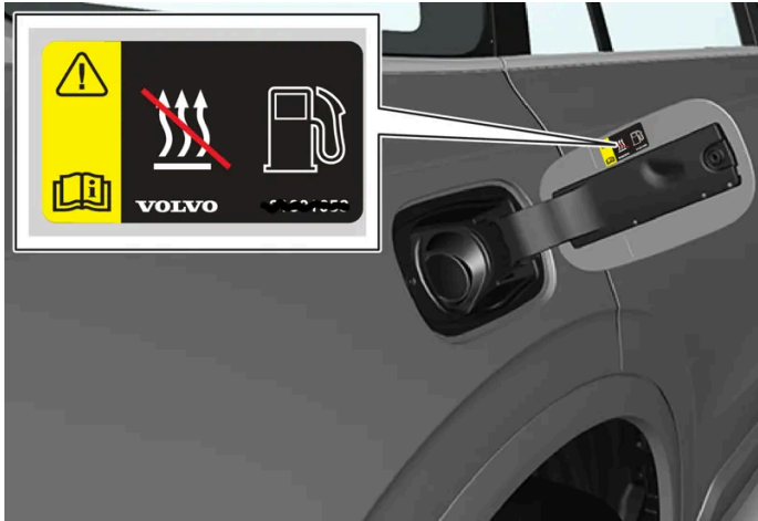
Warnaufkleber auf der Kraftstofftankklappe.
