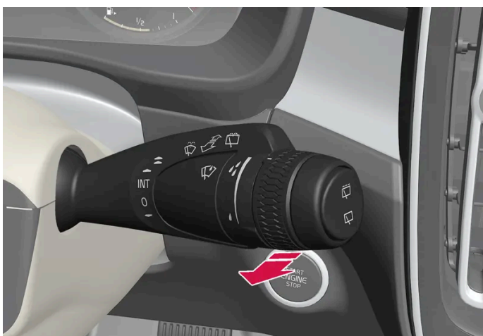
Waschfunktion, rechter Lenkradhebel.
