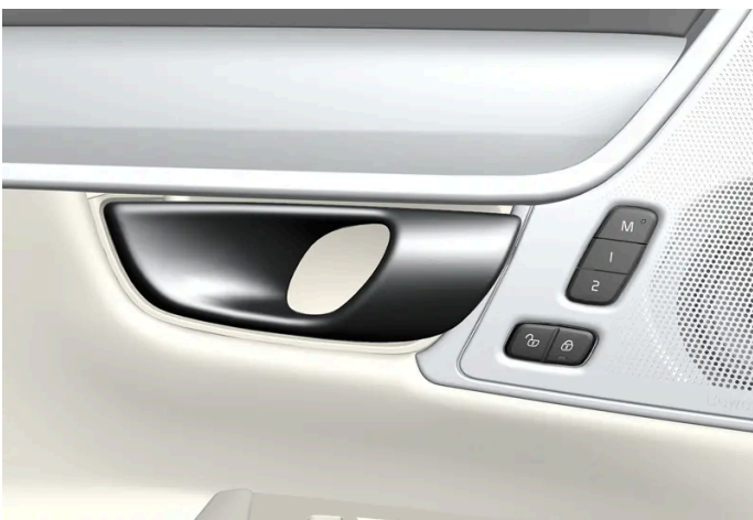
Griff zum alternativen Entriegeln der Tür [1] .
