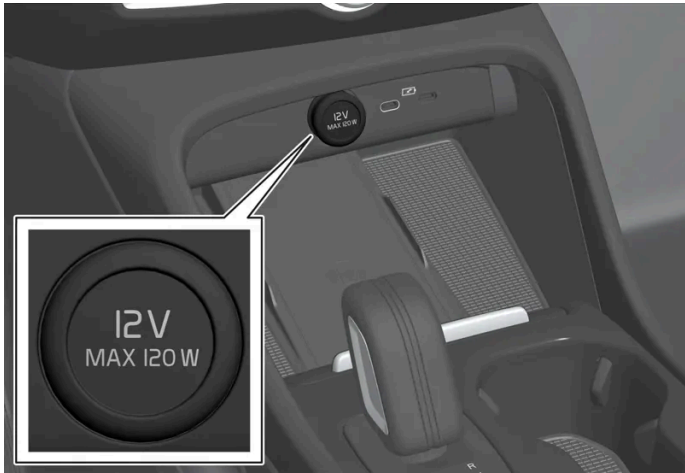
12-V-Steckdose in der Tunnelkonsole, vorn.
