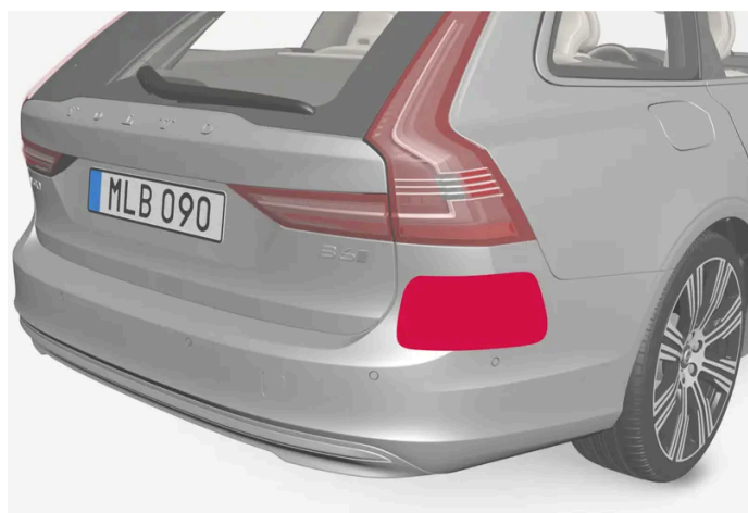
Lage der hinteren Radarmodule
