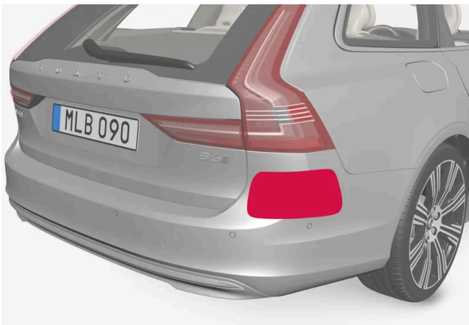
Lage der hinteren Radarmodule
