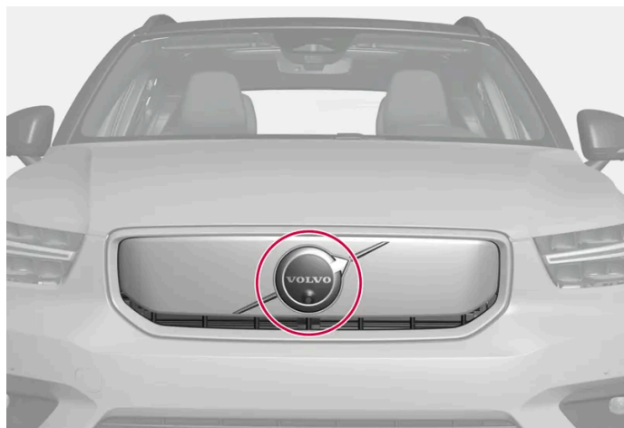
Lage des vorderen Radarmoduls
