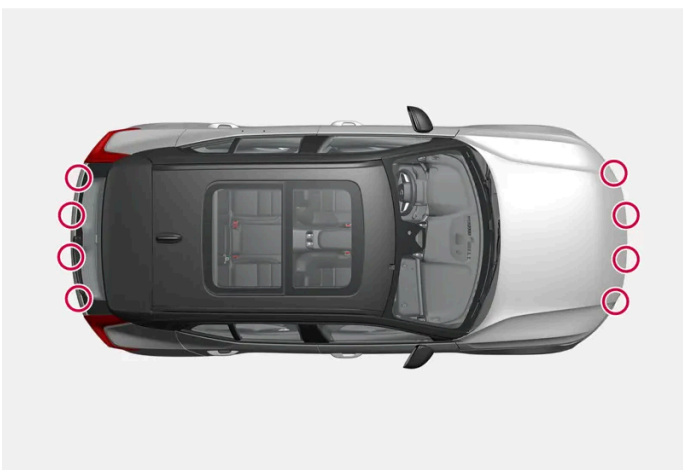
Lage der Einparkhilfesensoren rund um das Fahrzeug
